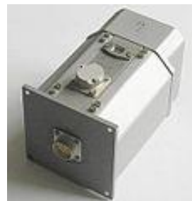
Подвійний трьохкомпонентний магнітометр для системи орієнтації мікросупутника
