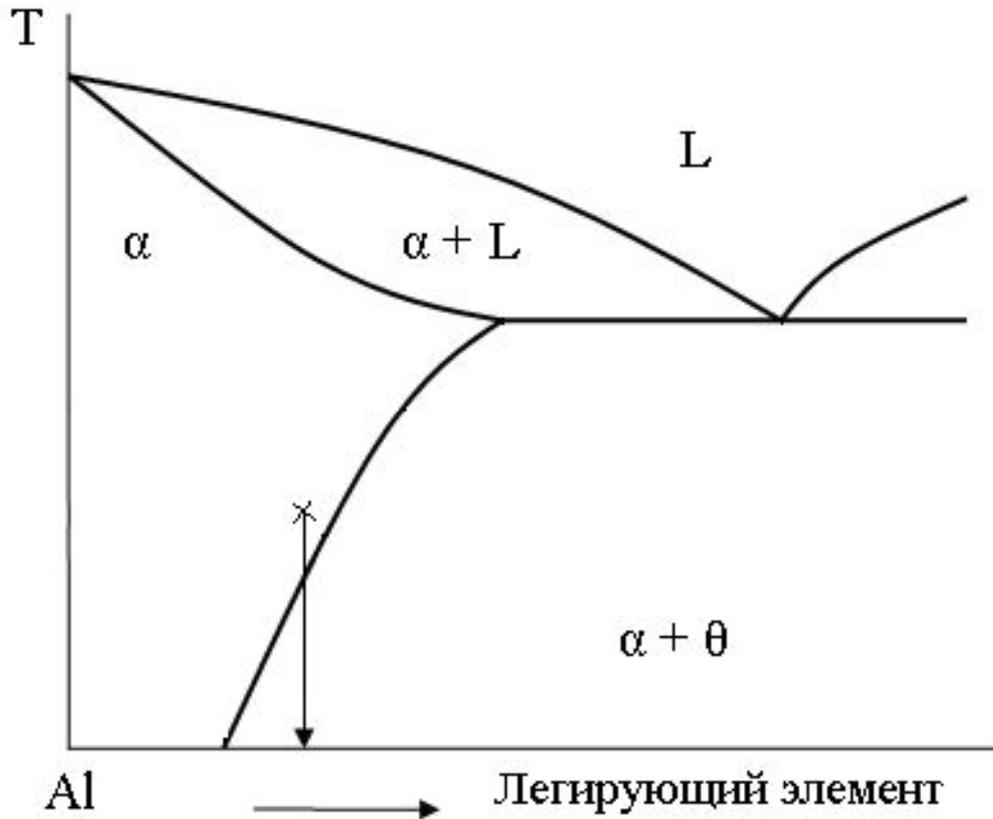
Старение— это термообработка, при которой в сплаве, подвергнутом закалке без полиморфного превращения, главным процессом является выделение дисперсных включений из пересыщенного твердого раствора. Наиболее широко применяется в сплавах Cu-Al.
