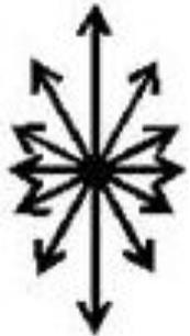
Если колебания происходят в различных направлениях, но в определенных направлениях амплитуды колебаний больше, чем в других, волна называется **частично поляризованной**.
