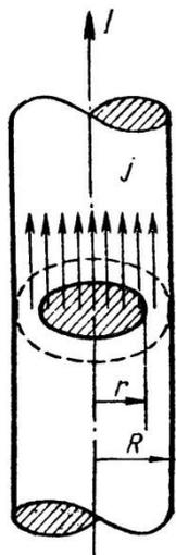
Если проводник прямолинейный и бесконечно длинный, то вдоль этой линии обхода напряженность магнитного поля будет везде одинакова и в каждой точке направлена по касательной (так как линия обхода совпадает с силовой линией,  $\cos \beta = 1$  в формуле
