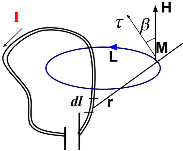
Проведем в магнитном поле замкнутую линию  $L$  и разделим ее на участки  $dl$ . Для каждого участка будет справедливо выражение  $H dl \cos \beta$  где  $\beta$  – угол между  $H$  и касательной  $\tau$  к линии. Просуммируем вдоль всей линии эти выражения
