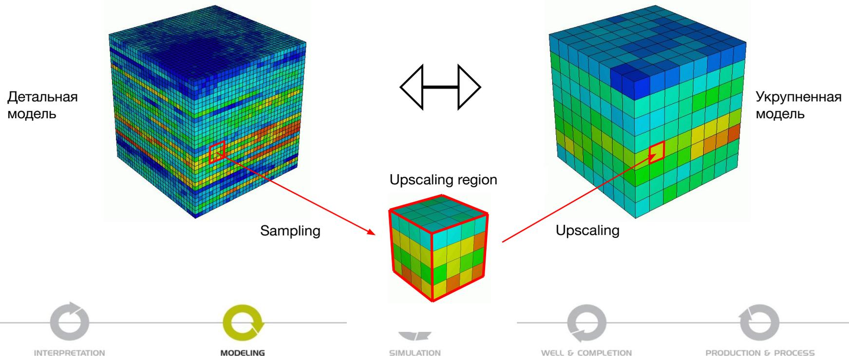
**Regridding** – изменение геометрии сетки за счет объединения ячеек (*downgridding*) или их измельчения (*upgridding*).
