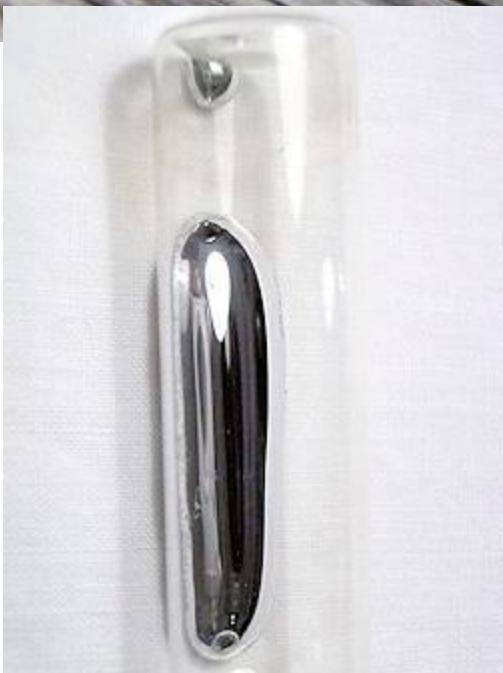
Ртуть – серебристый жидкий металл при нормальных условиях (выше 38,97°). Применяется в электротехнике, светотехнике, приборостроении для ртутных выпрямителей, кварцевых ламп.
