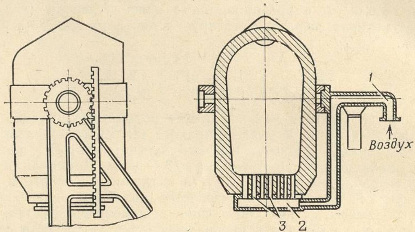
Рис. 1.2. Схема конвертора:
