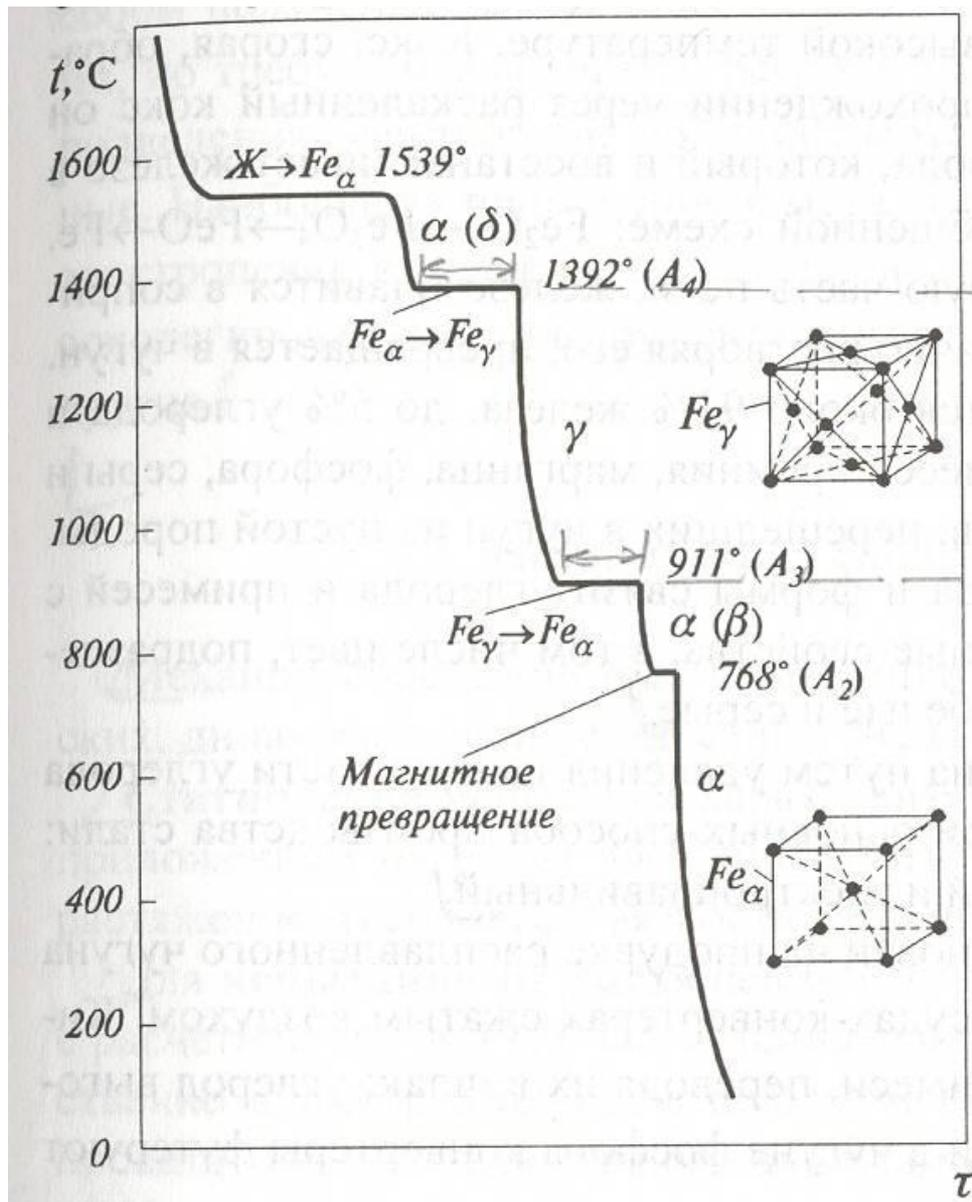
Рис. 7.3. Кривая охлаждения (нагрева) железа
