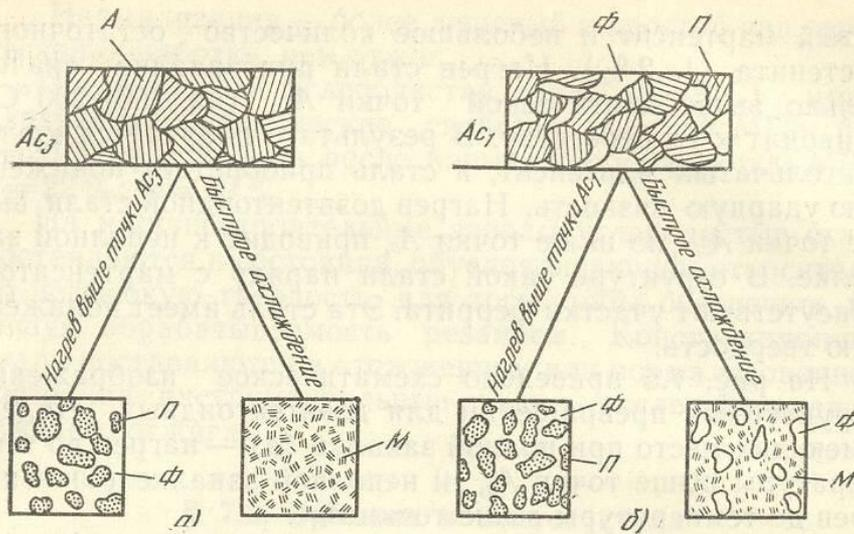
Рис. 7.5. Структурные превращения в доэвтектоидной стали при закалке:
