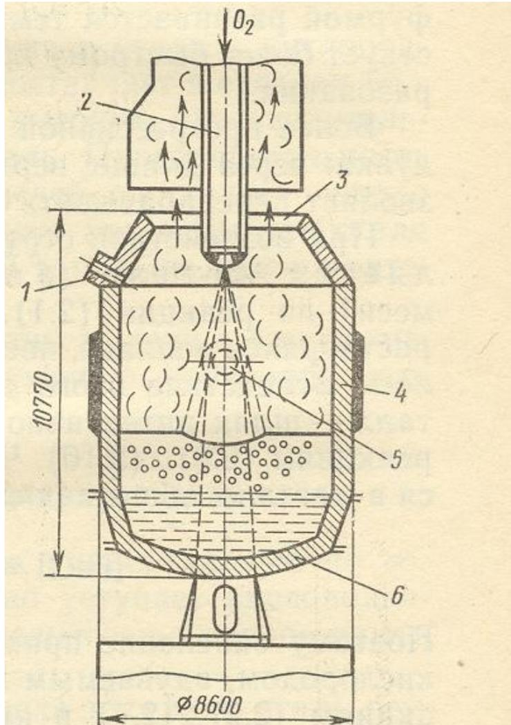
Рис. 2.2. Схема кислородного конвертера с рабочим объемом 270 м<sup>3</sup>
