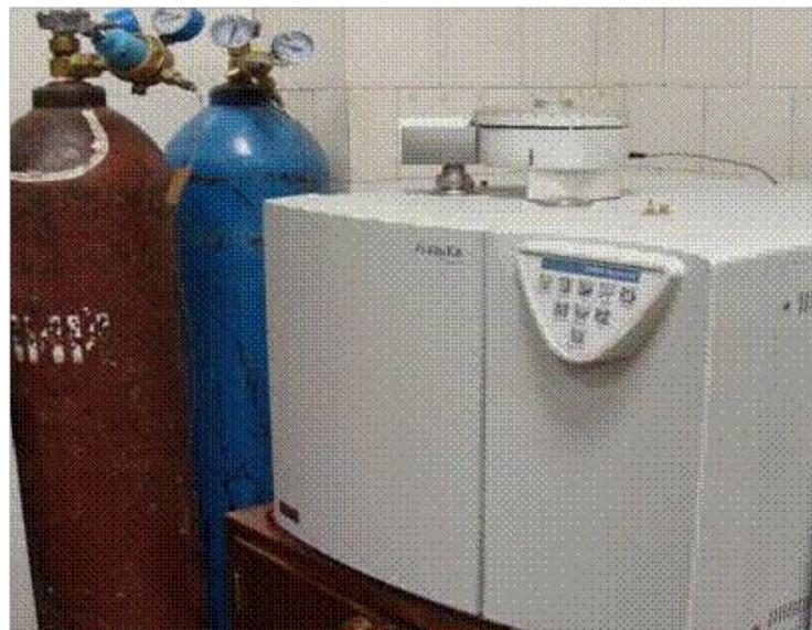
Позволяет определять содержание углерода, водорода, азота, серы и кислорода в жидких и твердых образцах. Однородные и неоднородные пробы анализируются в широком диапазоне концентраций (от 100 ppm до 100%) с высокой точностью и воспроизводимостью.
