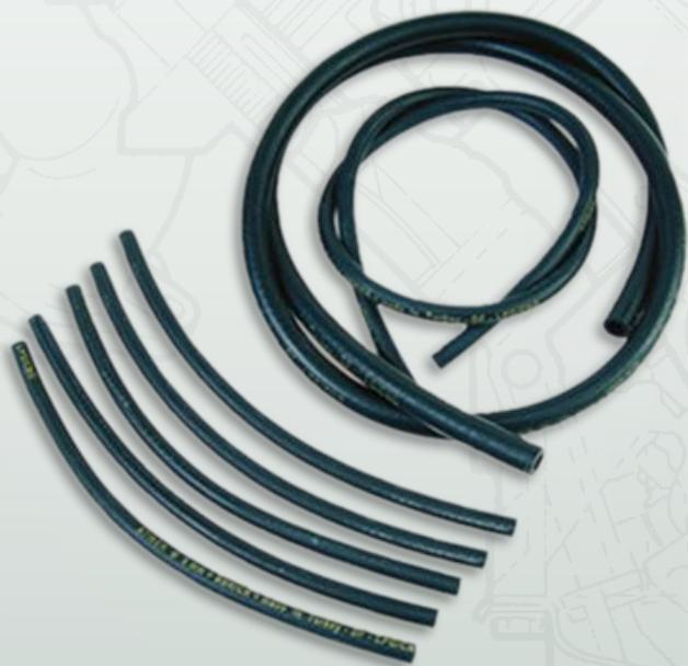
Газовый рукав применяется для соединения между редуктором, газовыми форсунками, датчиком давления и разрежения (MAP), и впускным коллектором.
