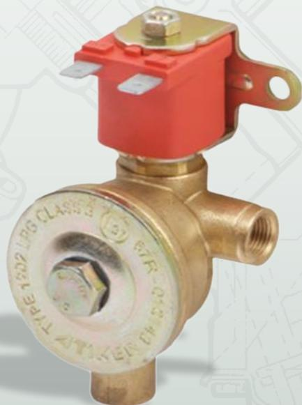
Электромагнитный клапан газа отсекает подачу газа к редуктору при выключенном зажигании, либо при работе двигателя автомобиля на бензине. Также в корпусе электромагнитного клапана газа установлен фильтр грубой (предварительной) очистки.
