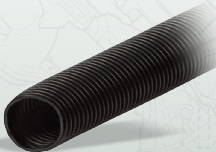
Применяется при установке мультиклапана тип 01 для цилиндрического баллона, в случае если в районе мультиклапана возникает утечка газа, то газ по каналам вентиляционной гофры отводится за пределы салона (багажного отделения) автомобиля.
