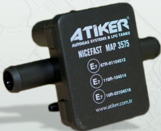
Измеряет давление газа на форсуночной планке, и разрежение в впускном коллекторе, относительно этих данных ЭБУ NiceFast вычислят необходимое количество газа, которое нужно подать для корректной работы двигателя автомобиля на разных режимах.
