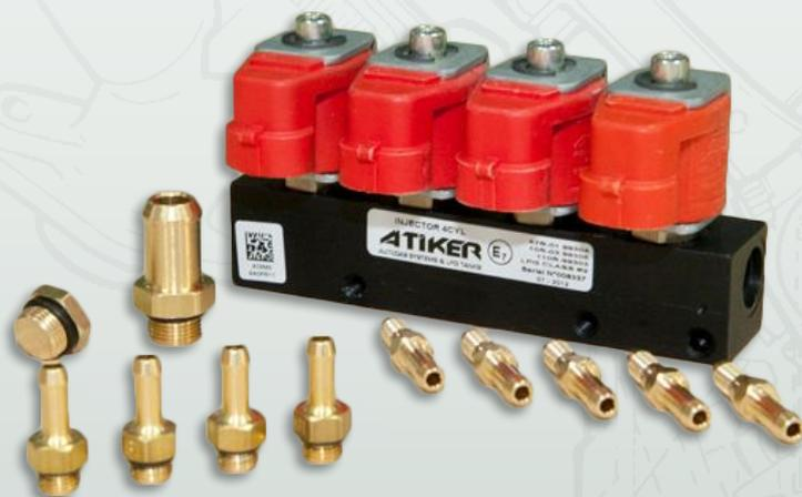
Служат для точного дозирования и подачи газового топлива в впускной коллектор (в непосредственной близости к впускным клапанам) двигателя автомобиля. Газовые форсунки повторяют полностью последовательность работы бензиновых форсунок, таким образом, чтобы последовательность работы газовых форсунок по отношению к впрыску бензина была одинаковой. Диаметр отверстий форсунок выбирается между 1,30 и 3,00мм, в зависимости от мощности двигателя.
