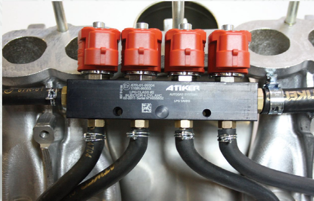
Установленные газовые форсунки
