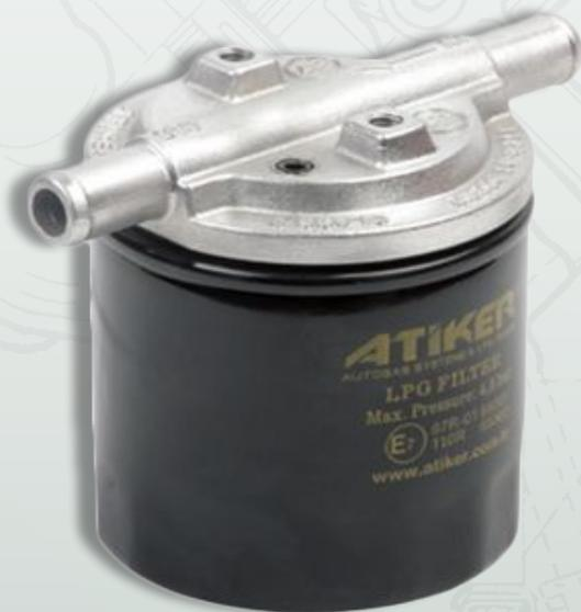
Устанавливается на газовой магистрали низкого давления между редуктором и форсуночной планкой, и служит для очистки испаренного газа от примесей, которые могут послужить причиной преждевременного выхода из строя газовых форсунок.
