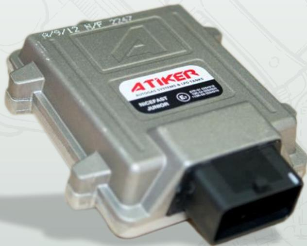
**NiceFast ECU (ЭБУ)** получает и обрабатывает сигналы таких датчиков как датчик температуры редуктора, датчик температуры газа, датчик уровня газа, датчик давления и разрежения (MAP сенсор), сигналы количества оборотов двигателя (RPM), времени впрыска бензиновых форсунок.
