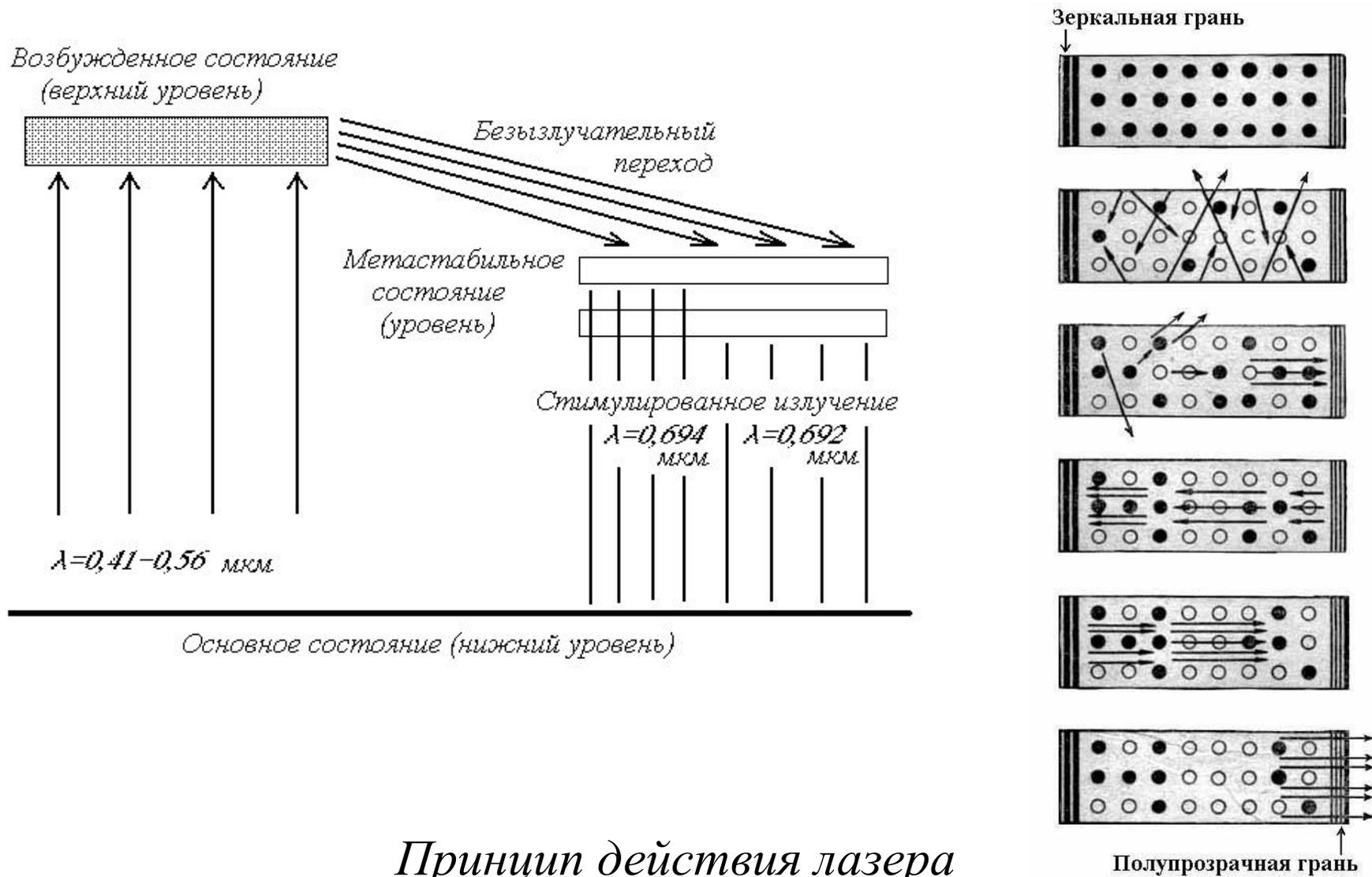
Принцип действия лазера
