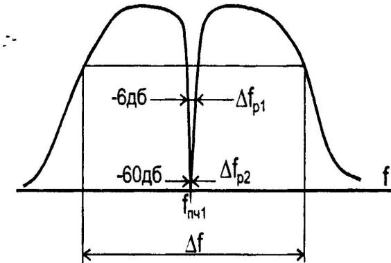
Приемное устройство выполнено по супергетеродинной схеме с двойным преобразованием частоты и имеет промежуточные частоты ( $f_{пч1} \pm f_{д}$ ) и ( $f_{пч2} \pm f_{д}$ ). Таким образом, происходит преобразование частоты  $f_0 \rightarrow f_{пч1} \rightarrow f_{пч2} \rightarrow f_{д}$  (демодулятор). В формирователе формируется прямоугольный сигнал с длительностью, пропорциональной частоте Доплера.
