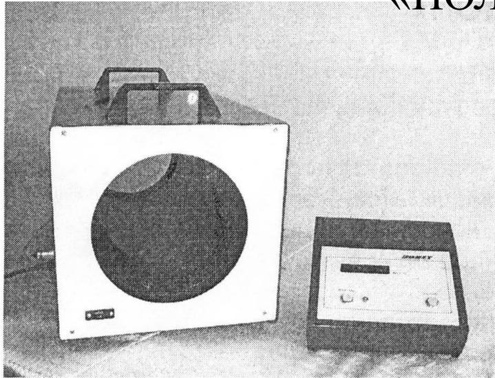
Прибор снабжен противоударной защитой электронно-оптических узлов от «неточных» выстрелов.
