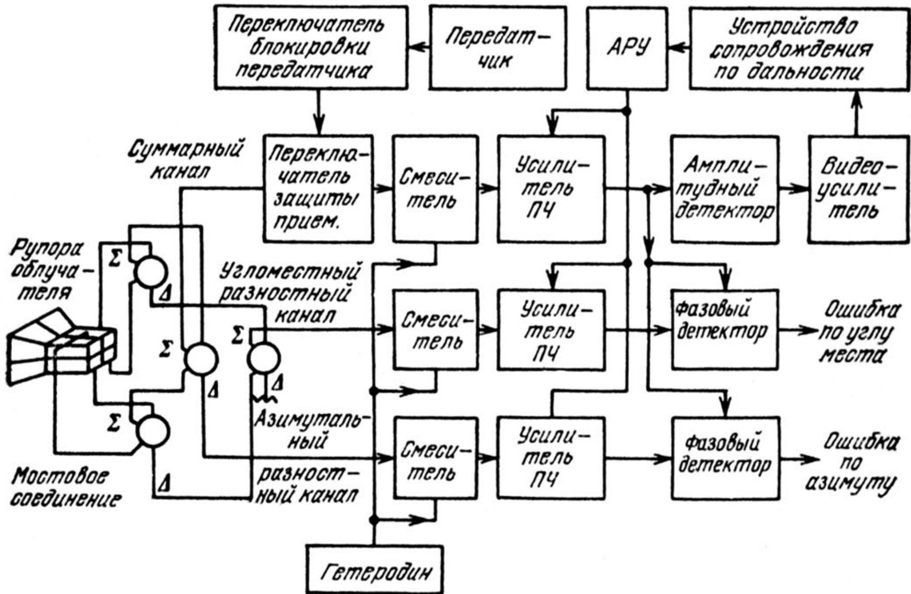
Схема моноимпульсного радиолокатора.
