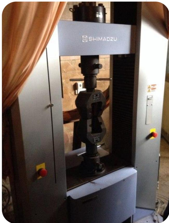
**Испытательная машина SHIMADZU AG-250 kNX**
