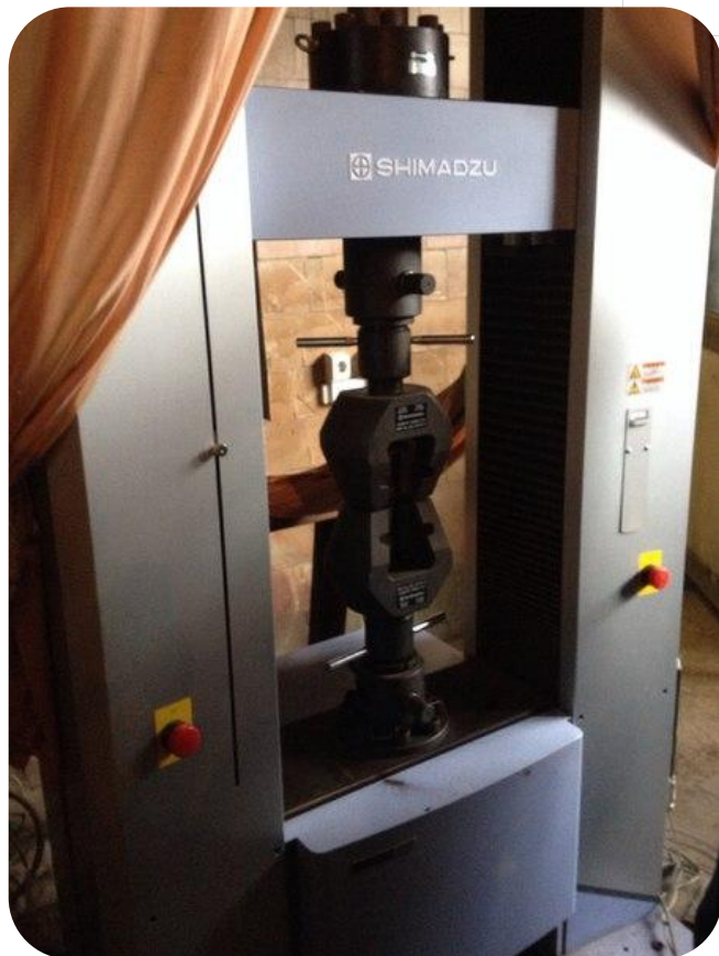
Испытательная машина SHIMADZU AG-250 kNX
