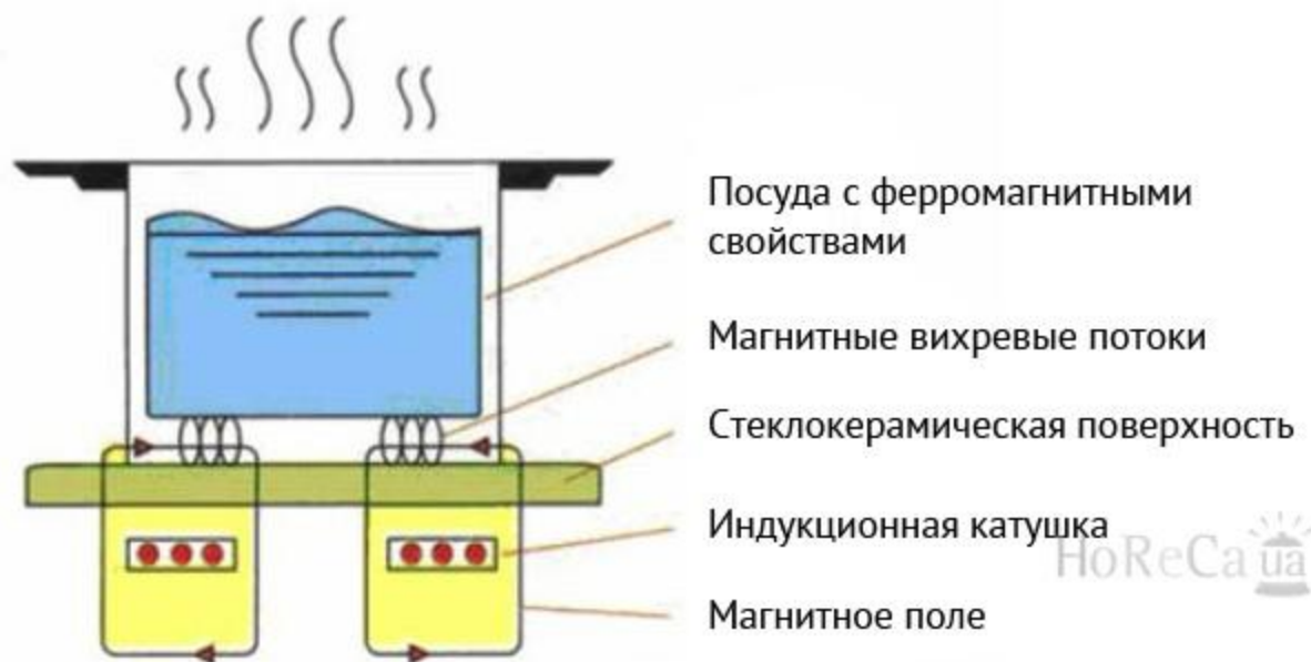
Рис.3. Принцип действия индукционной плиты
