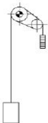
Рис. 7.1.4.3. Канатная система с верхним расположением лебедки, привод с двойным обхватом, кратность канатной подвески 1.
