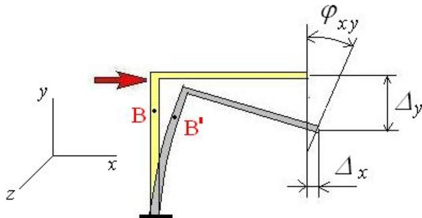
Перемещения - изменение положения поперечного сечения стержня в пространстве:
