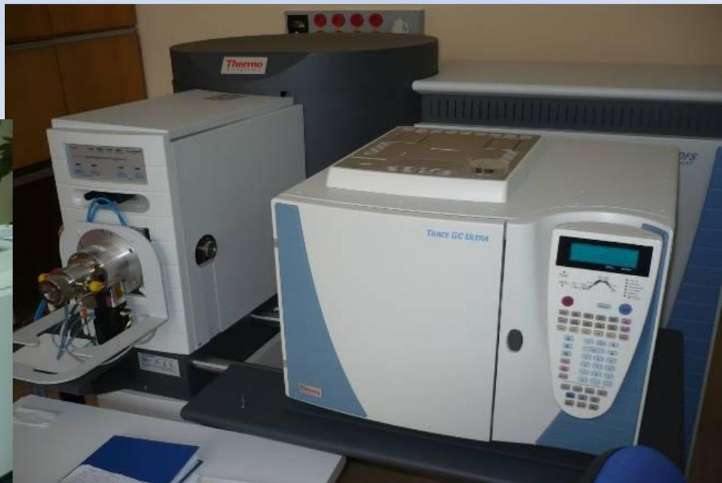
**Рис. Масс-спектрометр высокого разрешения Thermo Electron DFS с газовым хроматографом Thermo Electron Trace GC Ultra**
