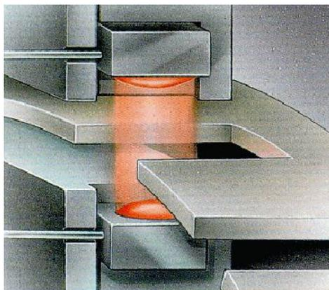
При положении когда фототранзистор закрыт диском, его проводимость практически нулевая, и +3.5В попадают на вход операционного усилителя, (1.5В гасятся на резисторе).
