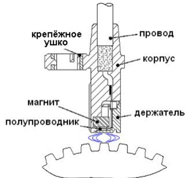
Генерируемый выходной сигнал датчика – синусоида. Уровень сигнала 7mA (логический 0), 14mA (логическая 1). Таким образом, для проверки датчика необходим осциллограф.
