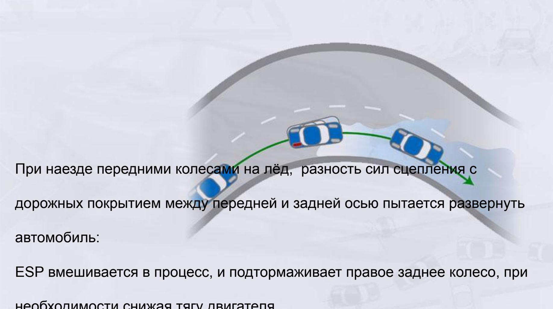
При наезде передними колесами на лёд, разность сил сцепления с дорожных покрытием между передней и задней осью пытается развернуть автомобиль:
