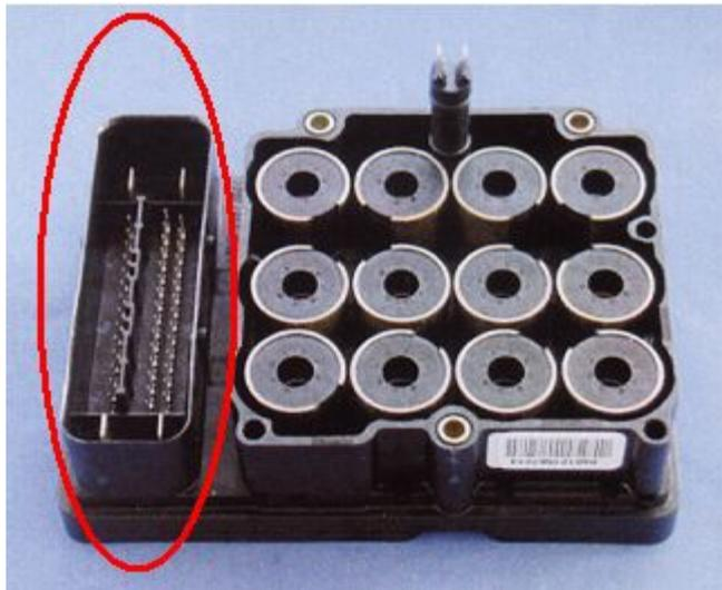
Электронный блок управления ESP выполняет следующие функции:
