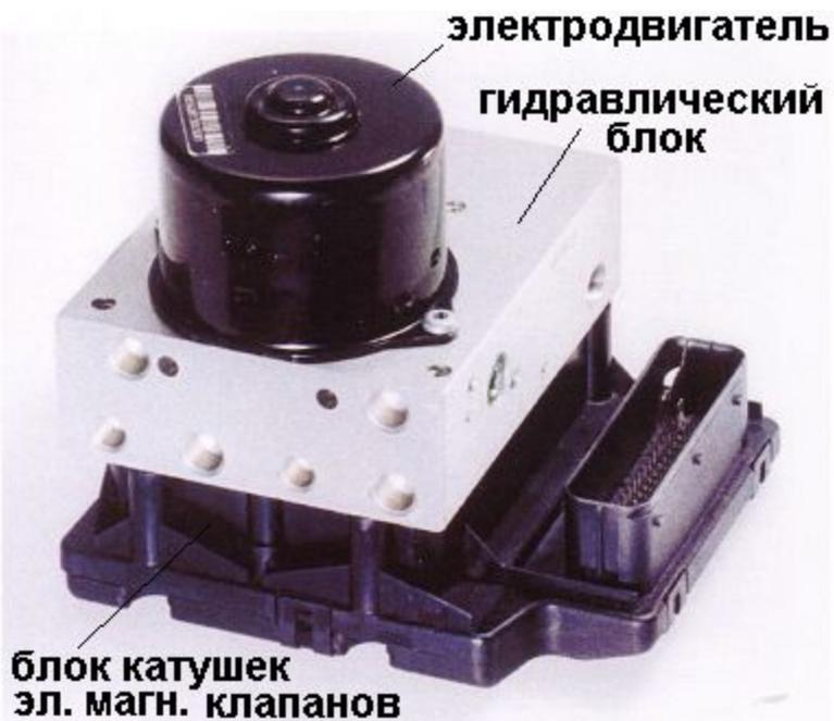
На автомобили JM устанавливаются ESP модели MGH-25 разработки компании MANDO Corp. В нём обе части
