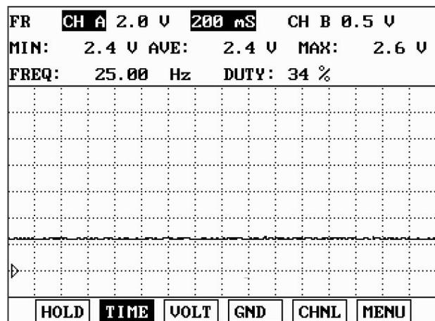
Опорное напряжение (движение по прямой)
