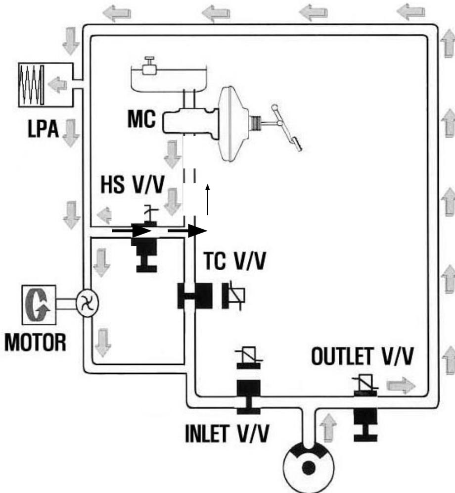
**При работе ESP (в случае слива - снижение давления)**
