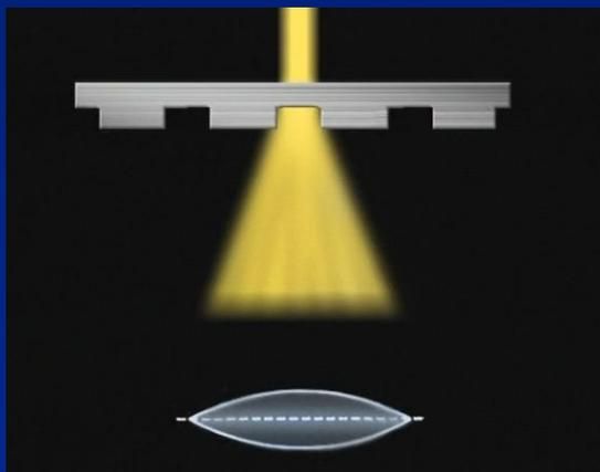
Дифракция светового потока (на краю рисунка световой поток расширяется и заходит в область геометрической тени)
