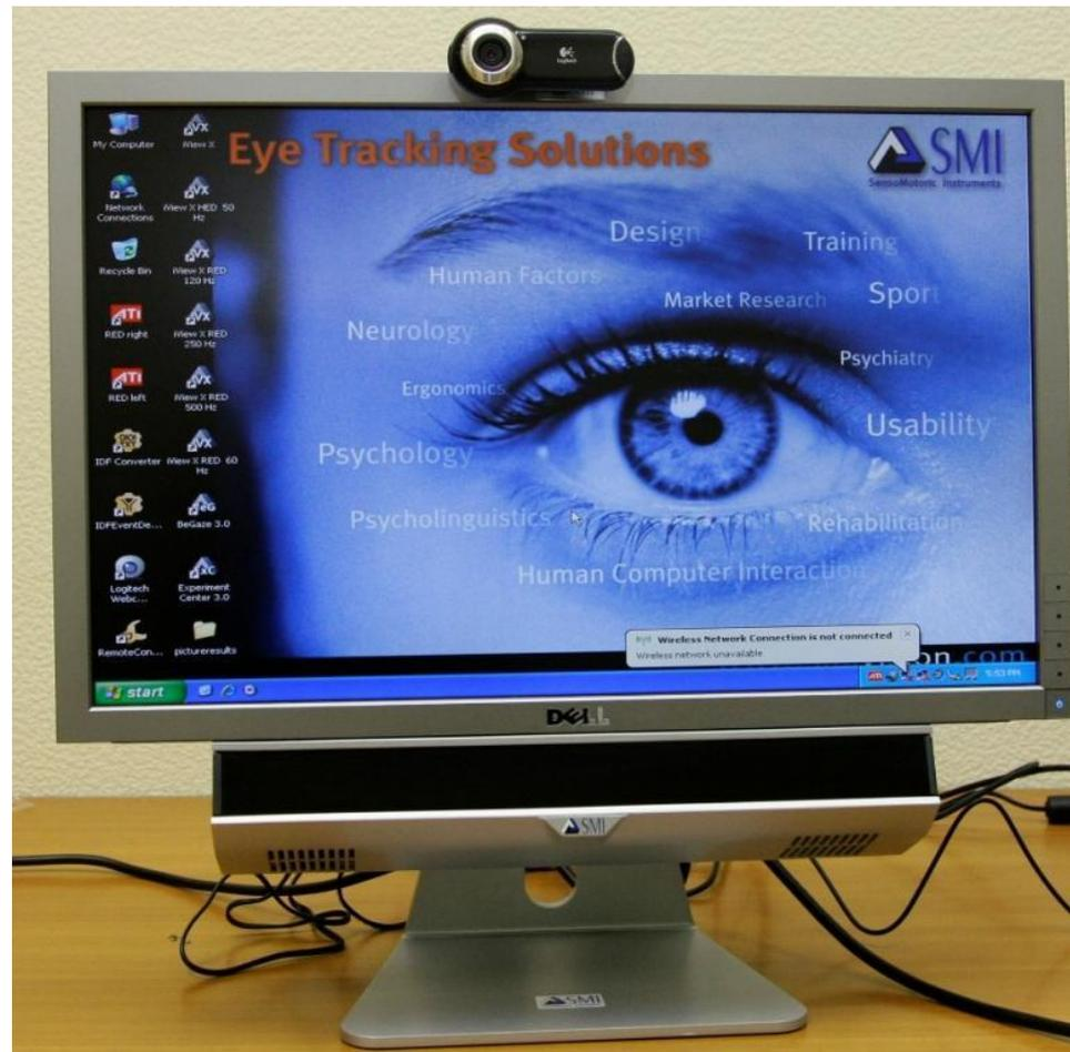
Монитор испытуемого с веб-камерой и стационарным ай-трекером
