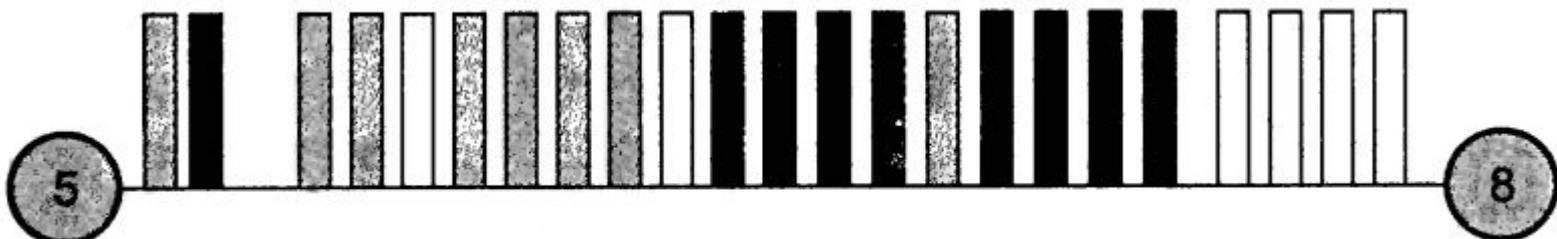
Суммарный поток из коммутатора 5 в сторону коммутатора 8
