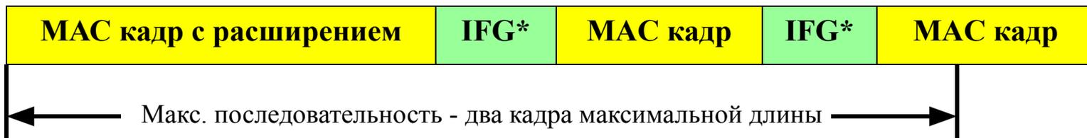
IFG\* - во время межкадрового интервала станция выдает в среду передачи символы расширения кадра. Ethernet и Fast Ethernet не поддерживают расширение кадров и packet bursting.
