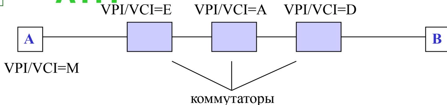
На этапе установления соединения все промежуточные АТМ устройства прописывают в свои таблицы коммутации правила перенаправления ячеек на основании конкретных значений VPI/VCI.
