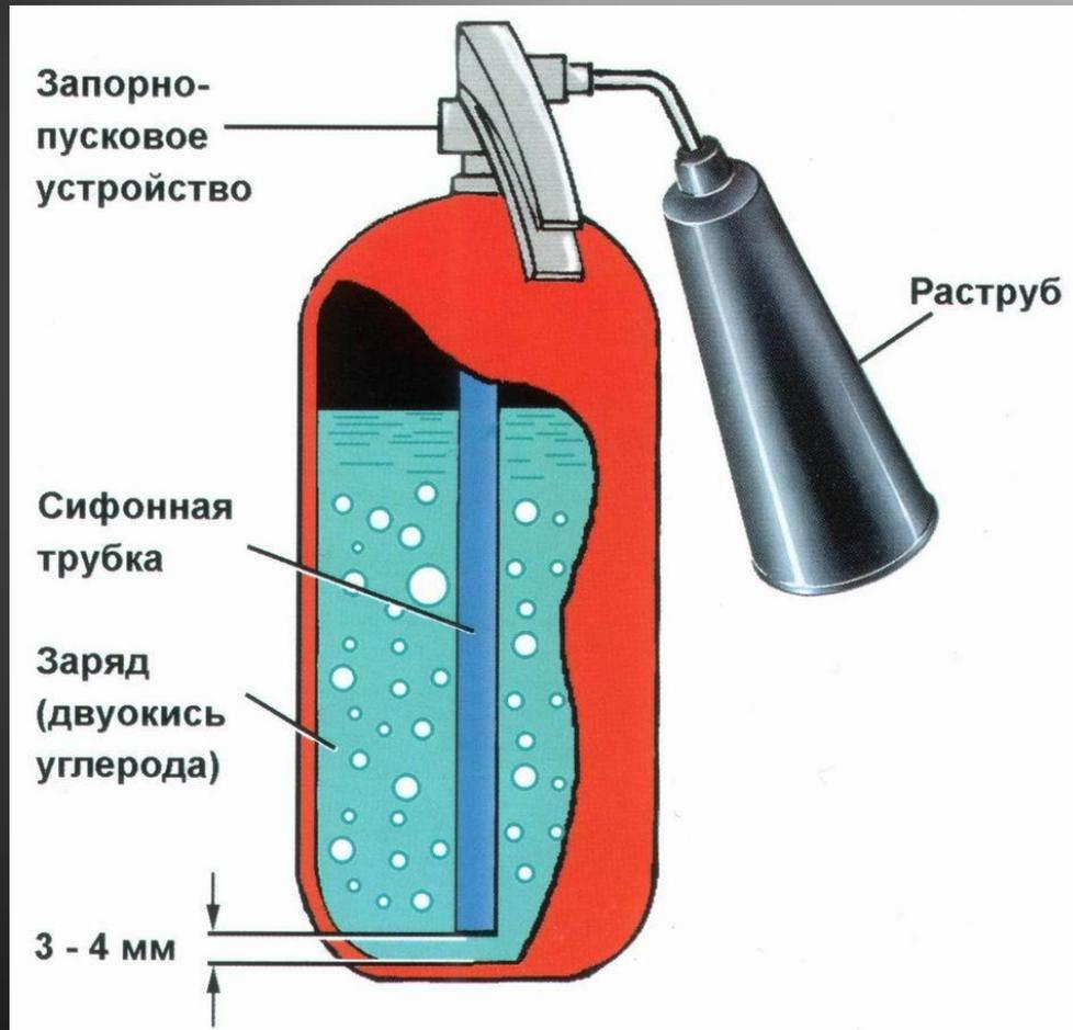
**Принцип действия основан на вытеснении двуокиси углерода избыточным давлением собственных паров. При открывании запорно-пускового устройства  $\text{CO}_2$  по сифонной трубке поступает к раструбу.  $\text{CO}_2$  из сжиженного состояния переходит в газообразное. Углекислота, попадая на горящее вещество, изолирует его от кислорода воздуха.**
