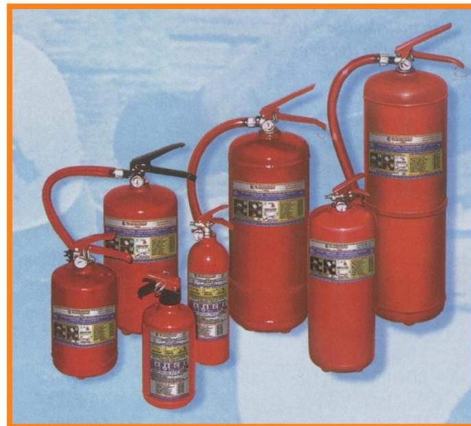
По объему корпуса огнетушители условно подразделяют на ручные малолитражные с объемом корпуса до 5 л (такой можно возить с собой в машине); промышленные ручные с объемом корпуса 5...10 л (для офиса или дома) ; стационарные и передвижные с объемом корпуса свыше 10 л (самый раз для промышленных предприятий).
