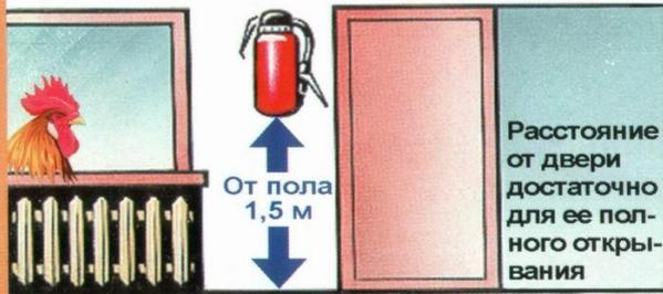
В общественных зданиях и сооружениях расстояние до места возможного возгорания должно быть не более 20 м
