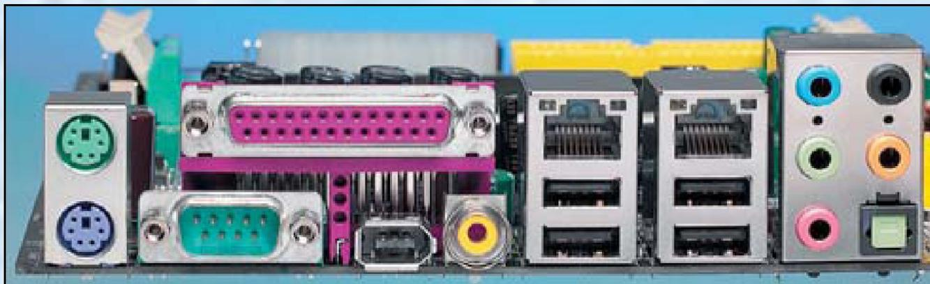
(слева направо): PS/2, IEEE-1284, RS-232, FireWire, видеовыход, два Gigabit Ethernet, USB 2.0 и восьмиканальный звук
