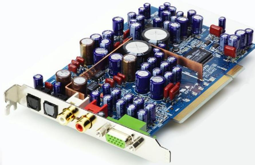
Компания Onkyo, производитель высококачественной бытовой аппаратуры, выпустила новую звуковую карту Onkyo SE-150 PCI с семиканальным звуком, который поддерживает стандарт EAX 2.0 и A3D, QSound и STEREO EXPANDER.
