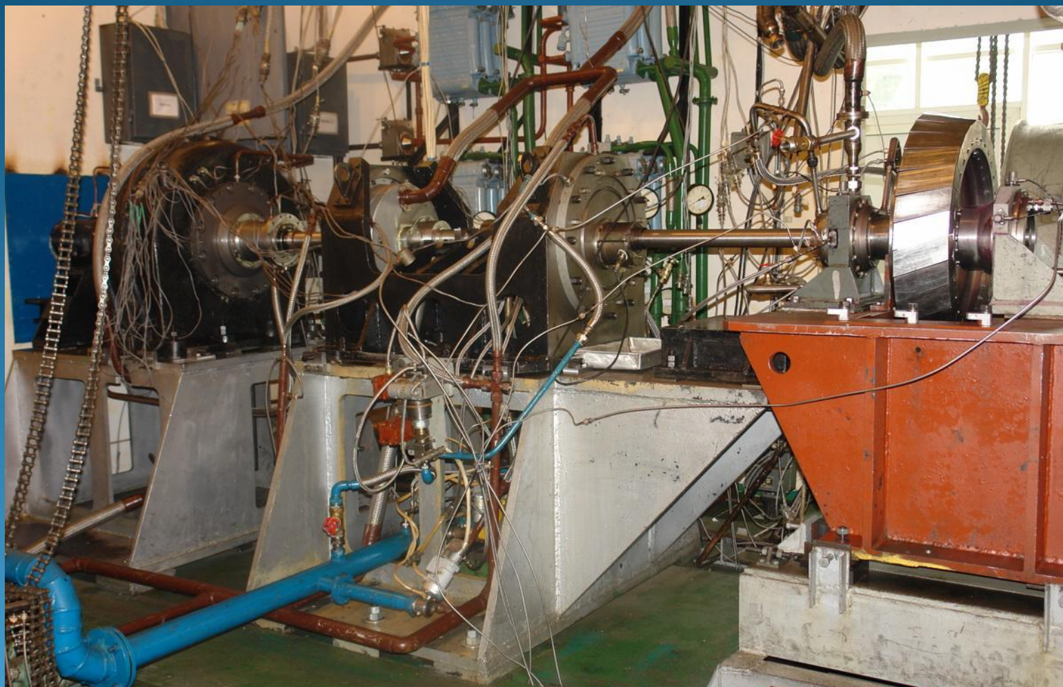
Установка испытательная разгонная (УИР-3) для испытания дисков компрессоров и турбин
