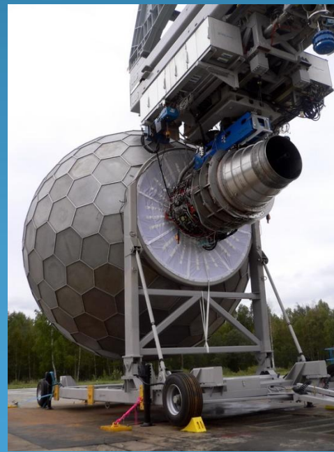
Оборудование открытого испытательного стенда для испытания ГТД с турбулентностью на входе для оценке запасов ГДУ
