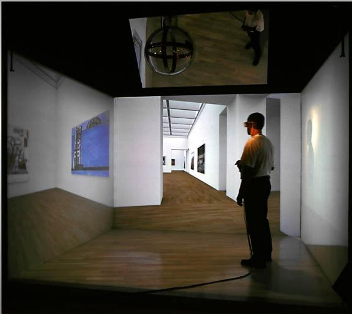
**Responsive Workbench** – разработанная в ИМК двухэкранный активная стерео-проекционная система. Для компактификации установки используется система больших зеркал высокого качества.
