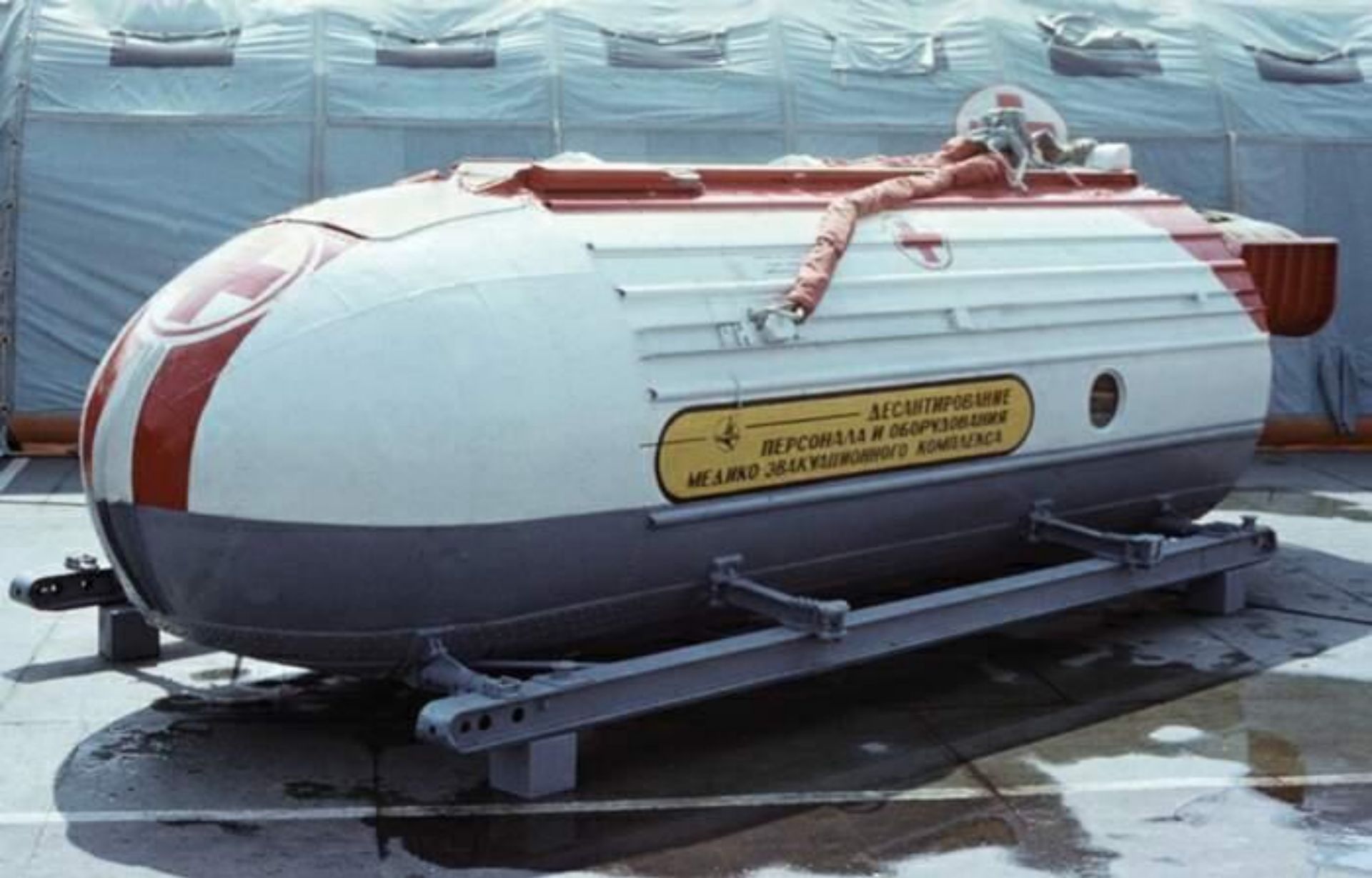
Капсула для десантирования медицинского персонала с 300 кг груза на воду и землю.
