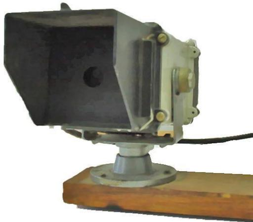
Датчик «Мак» предназначен для обнаружения нарушителя линии охраны. Датчик применяют для создания зоны обнаружения вдоль основного ограждения объекта охраны (главным образом по верху ограждения), крыш зданий КПП, у оконных проемов, дверей охраняемых зданий, на проезжей части дорог в районе КПП и т.п.
