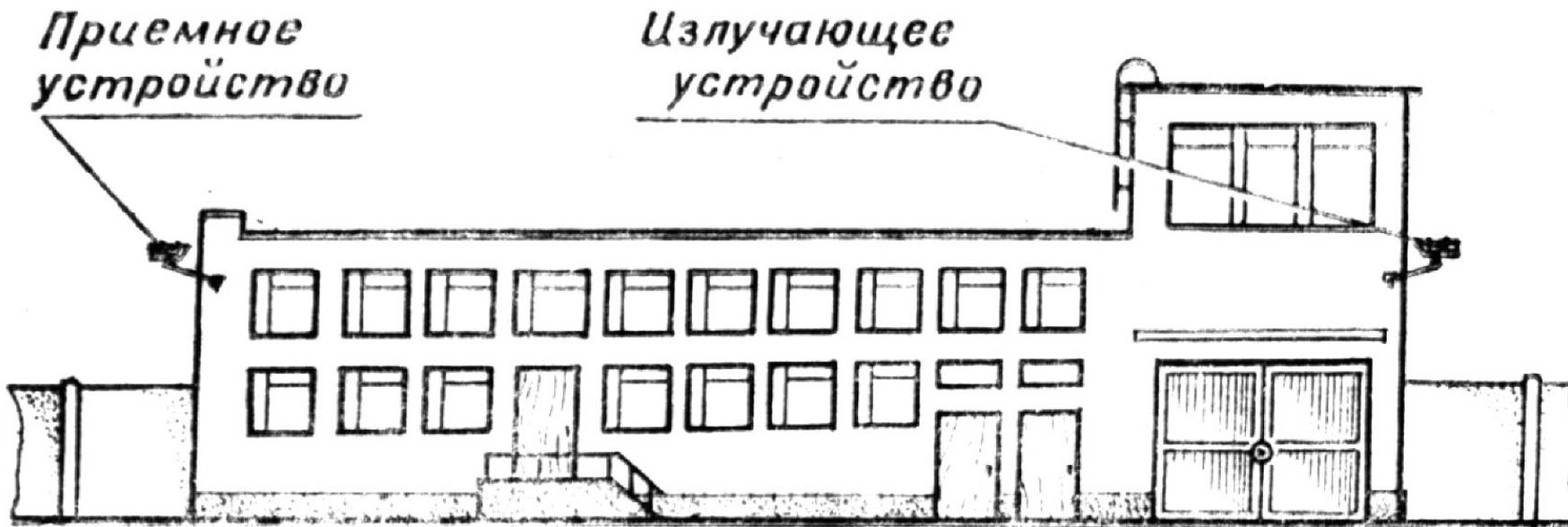
Вариант установки датчика обнаружения "МАК" для прикрытия крыши здания
