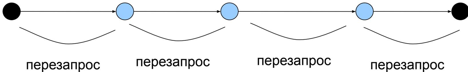
Т.о., перезапросы приводят к необходимости дополнительного буфера на промежуточных узлах и к существенному понижению скорости. Следовательно, для построения больших сетей X.25 непригодна.
