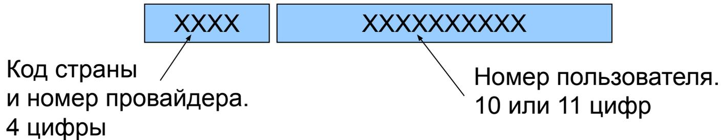
Логический адрес назначается для каждого соединения.
