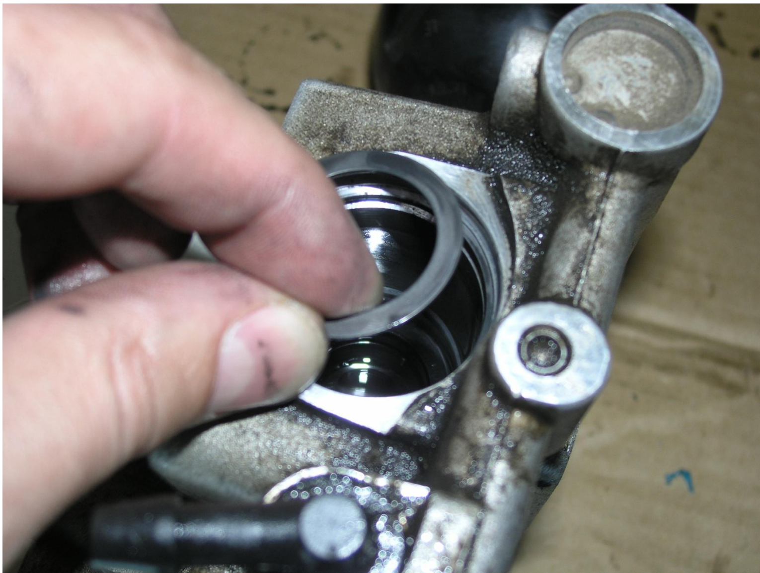
8. Пальцами извлекаем упорную шайбу манжеты рабочего цилиндра сцепления
