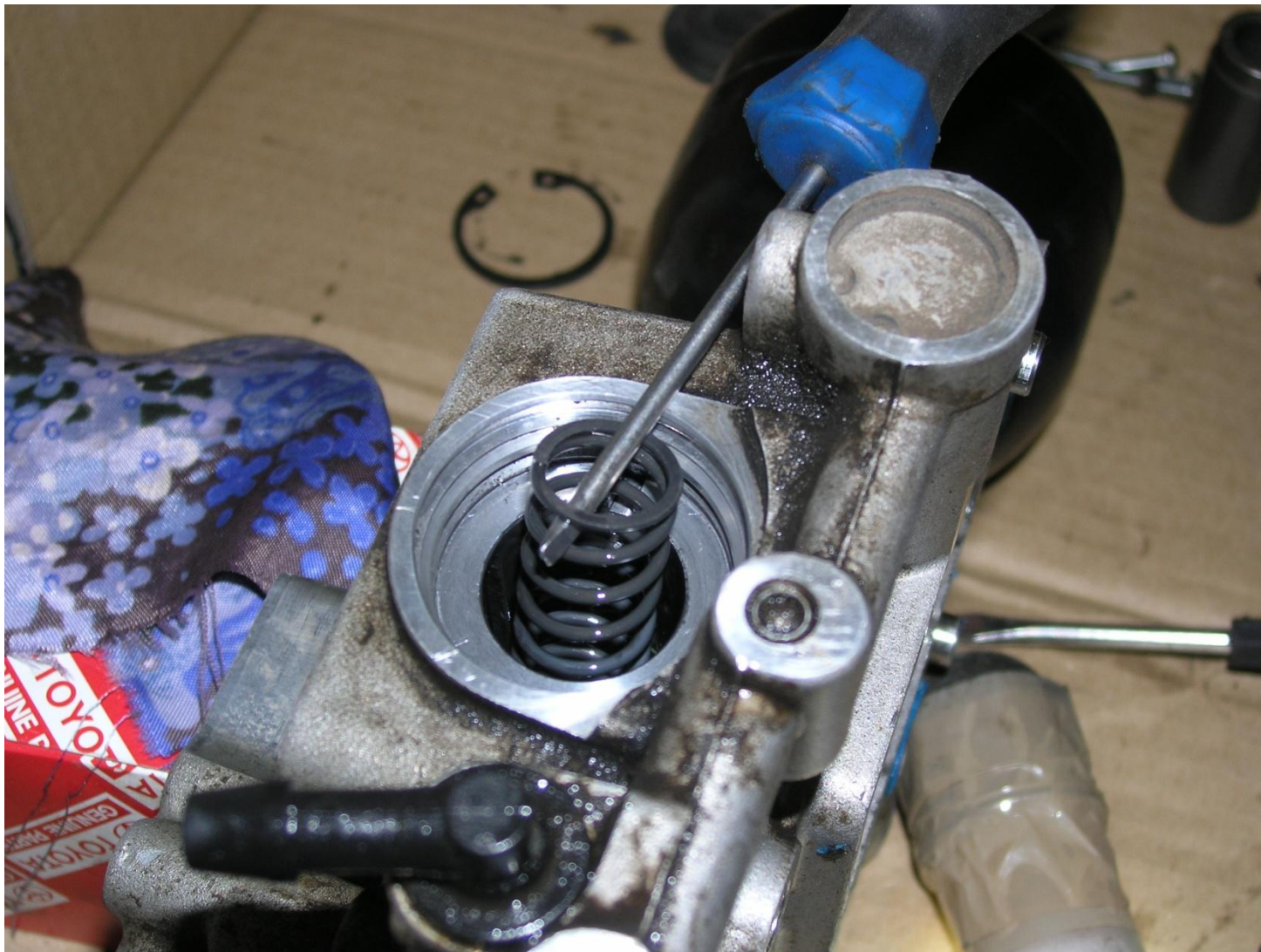
5. Извлекаем пружину поршня
