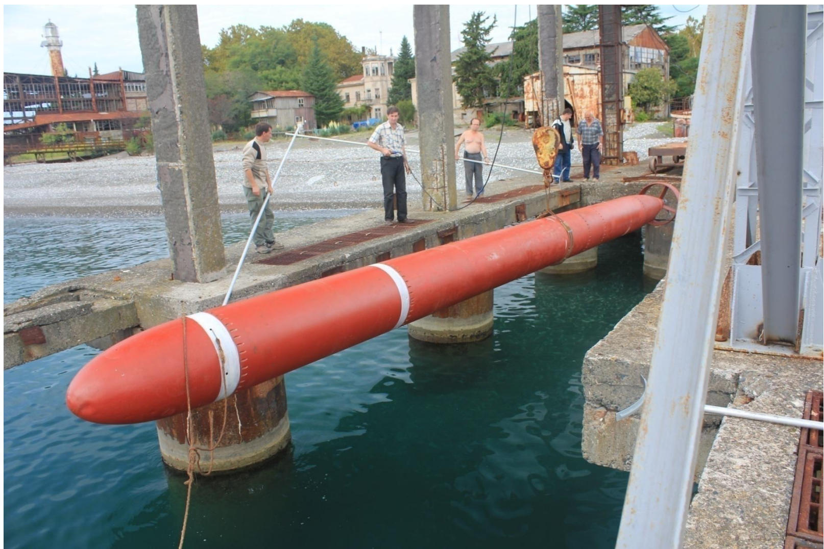
Рис.15. Старт погружения Всплывающего Устройства для буксировки.
