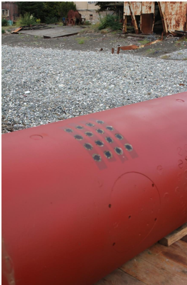
Рис. 11. Измерительный отсек с датчиками турбулентных пульсаций давления.
