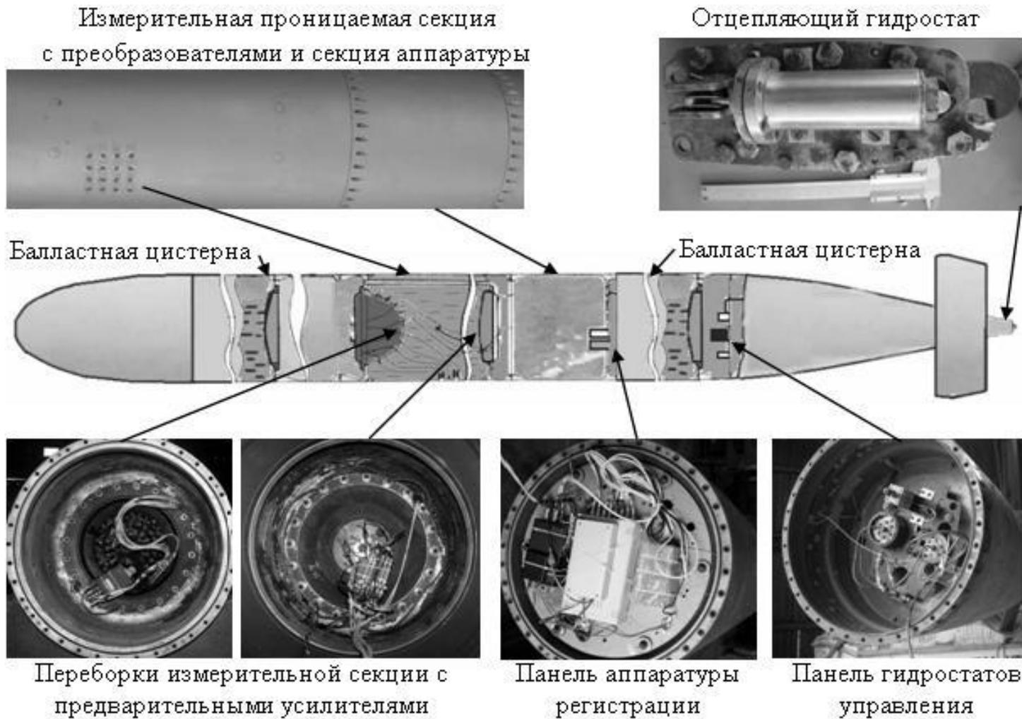
Рис. 12. Измерительная секция
