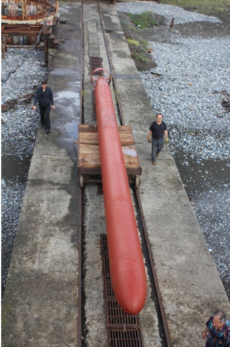
Рис. 10. Транспортировка Всплывающего Устройства на береговую Эстакаду
