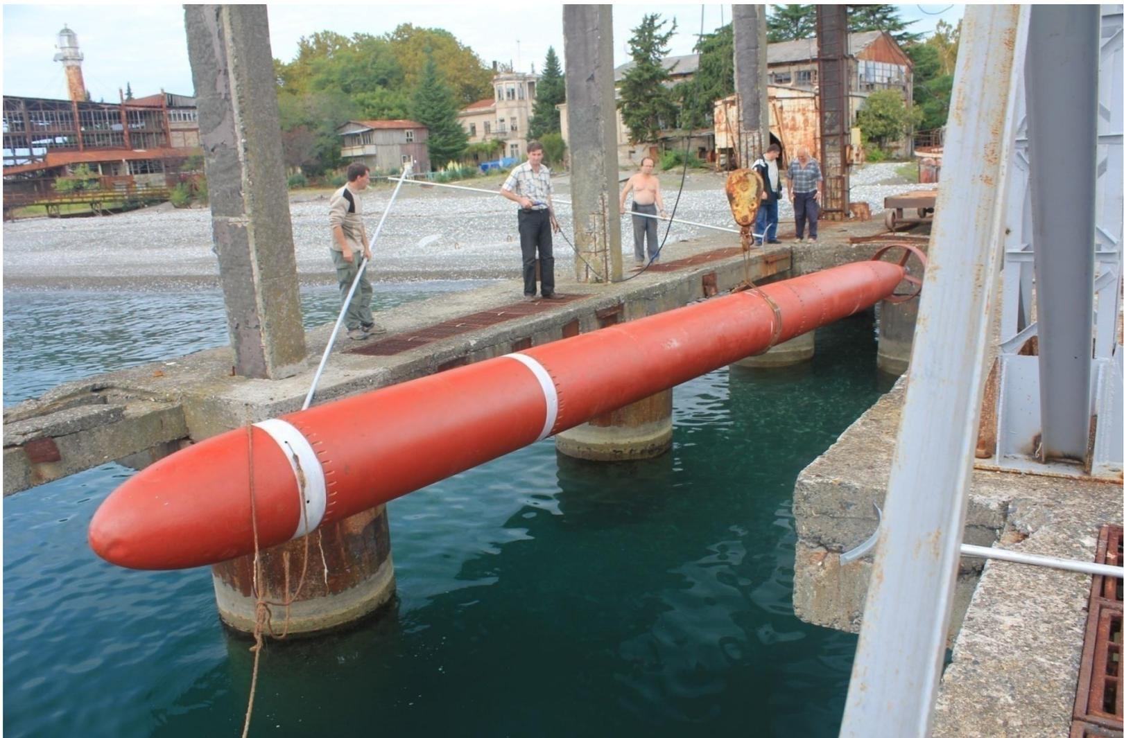
Рис.15. Старт погружения Всплывающего Устройства для буксировки.
