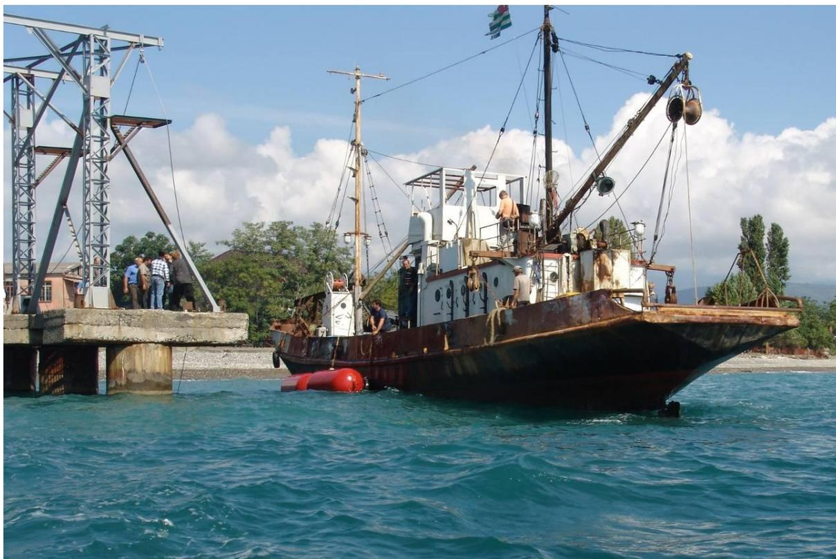
Рис.6. Выполнение морской постановки якоря, оснащённого донным блоком.
