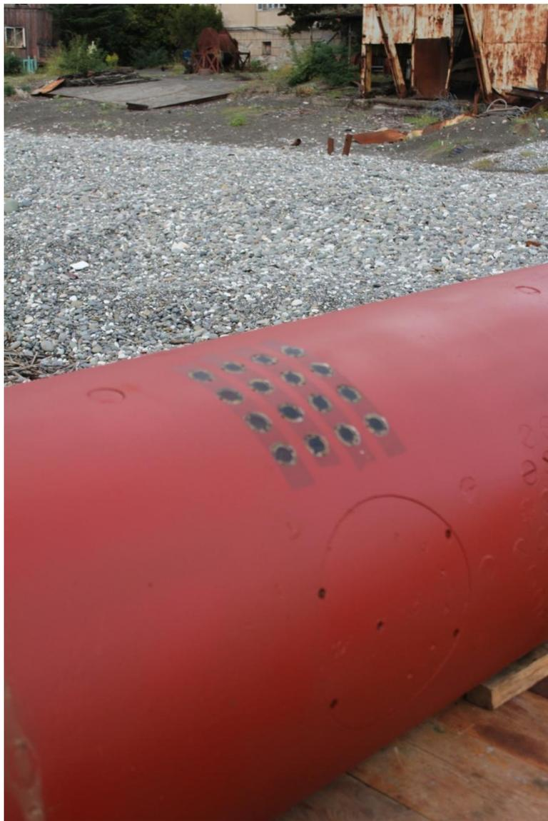
Рис. 11. Измерительный отсек с датчиками турбулентных пульсаций давления.
