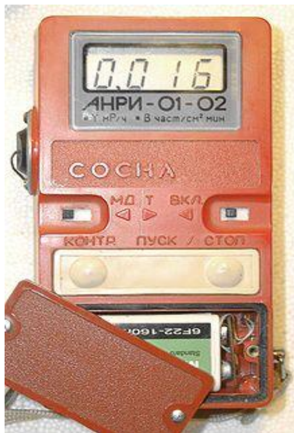
Устаревший бытовой дозиметр-радиометр «Сосна» (СССР, 1992). Батарейный отсек приоткрыт. Показывает 16 микрорентген/час.
