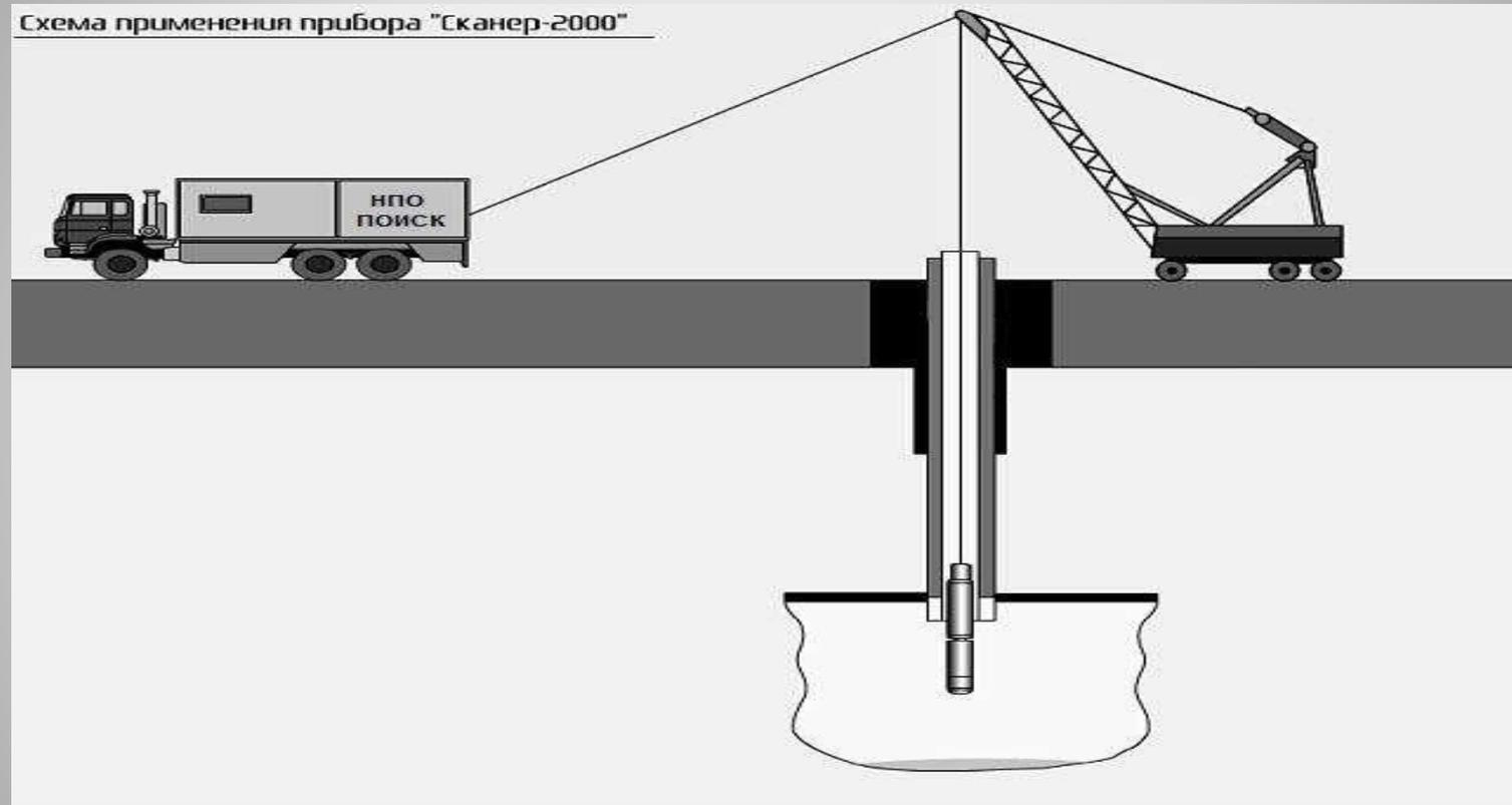
**Схема применения эхолотационного комплекса
