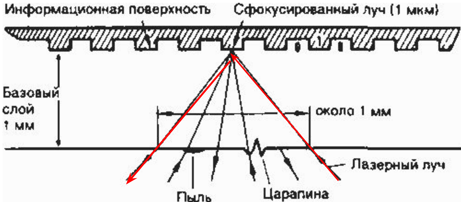
Рис. 5 Лазерный луч считывает информацию со стороны базы
