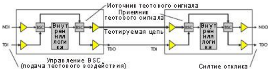
Использование JTAG для тестирования межсоединений
