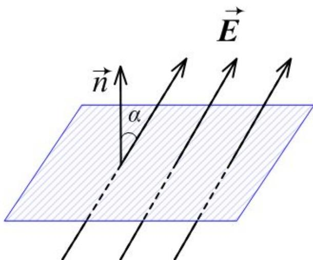
В простейшем случае, если величина вектора  $\vec{E}$  одинакова на всей поверхности и угол, под которым вектор  $\vec{E}$  «пронизывает» поверхность везде одинаков, поток  $\Phi_E = ES \cos\alpha$ .
