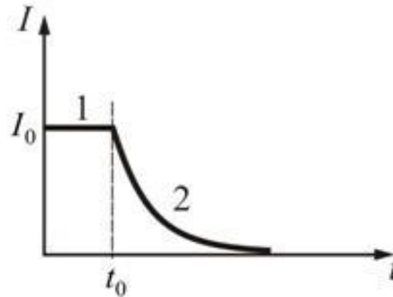
При размыкании реальных цепей с большой индуктивностью возникающее высокое индуцированное напряжение создает искру или даже дугу в месте разрыва. Это является проблемой.
