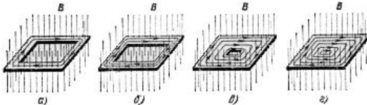
На рис. показано несколько таких «витков» со все возрастающей толщиной; последний представляет собой просто сплошную металлическую пластинку, помещенную в изменяющееся магнитное поле. Если вместо тонкой пластинки взять толстый кусок металла, то при помещении его в изменяющееся магнитное поле такой кусок металла, нагревается; иногда это нагревание довольно сильно.
