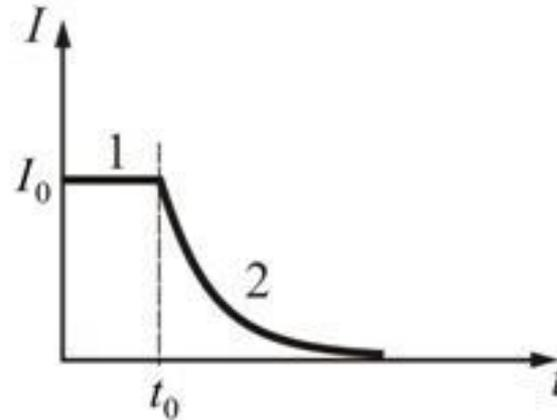
При  $t = 0$  отключим источник тока, замкнув одновременно цепь накоротко (переведем ключ из положения 1 в 2). Как только сила тока начнет убывать, возникнет ЭДС самоиндукции, противодействующая этому, а сила тока в цепи будет по закону Ома удовлетворять выражению:
