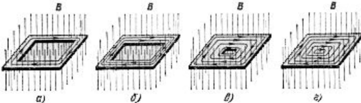
В проводнике, помещенном в изменяющееся магнитное поле, возникает индукционный ток, нагревающий проводник:
