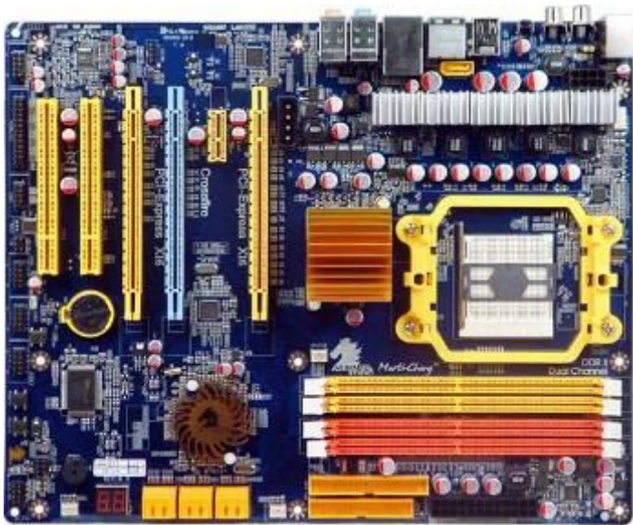
Полимерные конденсаторы с твёрдым электролитом на чипсете
