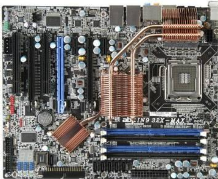
Полимерные конденсаторы с твёрдым электролитом на чипсете
