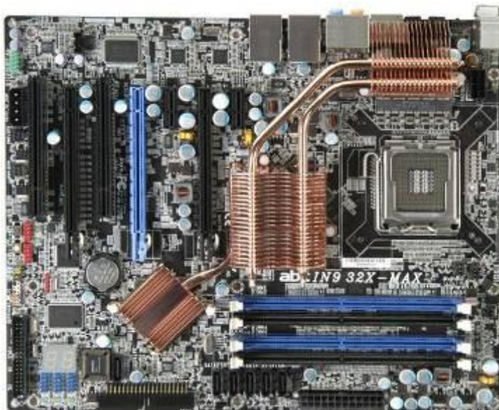
Полимерные конденсаторы с твёрдым электролитом на чипсете
