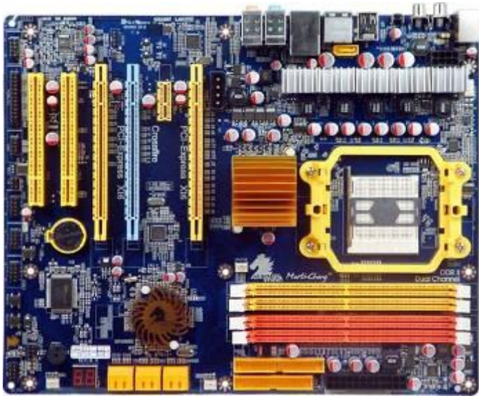
Полимерные конденсаторы с твёрдым электролитом на чипсете
