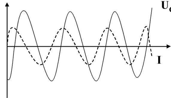
Физический смысл этого заключается в следующем: чтобы возникло напряжение на конденсаторе, должен натечь заряд за счет протекания тока в цепи. Отсюда происходит отставание напряжения от силы тока.
