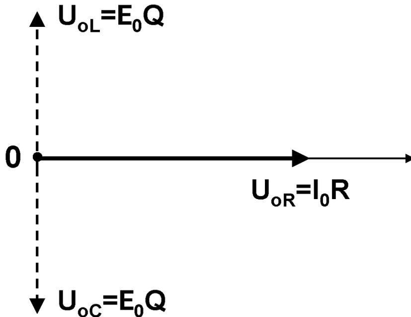
Таким образом, при резонансе колебания напряжения на индуктивности и емкости имеют одинаковы амплитуды, но так как они сдвинуты на  $[\pi/2 - (-\pi/2)] = \pi$  их сумма равна нулю, и остается только колебание напряжения на активном сопротивлении.
