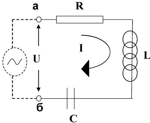
Вычислим напряжение всей цепи, сложив графически падения напряжения на каждом элементе цепи.
