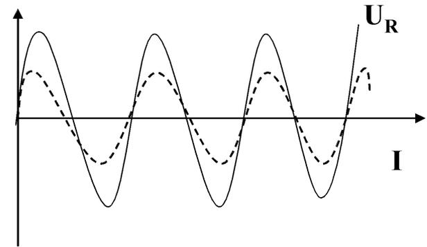
При небольших значениях частоты переменного тока активное сопротивление проводника не зависит от частоты и практически совпадает с его электрическим сопротивлением в цепи постоянного тока.
