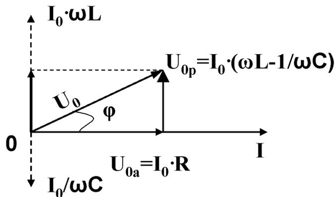
Так как сумма проекций векторов на произвольную ось равна проекции суммы этих векторов на ту же ось, то амплитуду полного напряжения можно найти как модуль суммы векторов:
