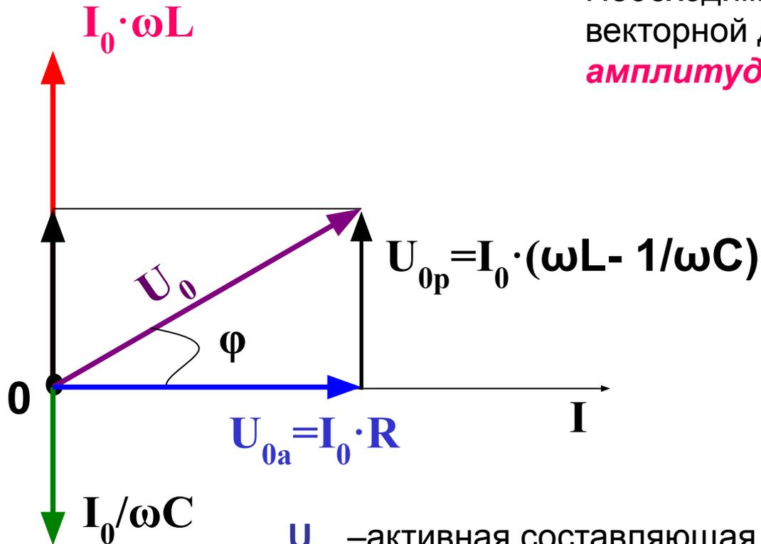
Таким образом, полное напряжение между концами цепи *a* и *б* можно рассматривать как сумму двух гармонических колебаний: напряжения  $U_{0a}$  и напряжения  $U_{0p}$ ,
