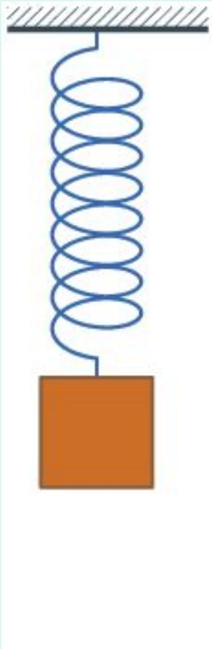
Рис . 3. Система груз-пружина без затухания, в которой происходит простое гармоническое движение.
