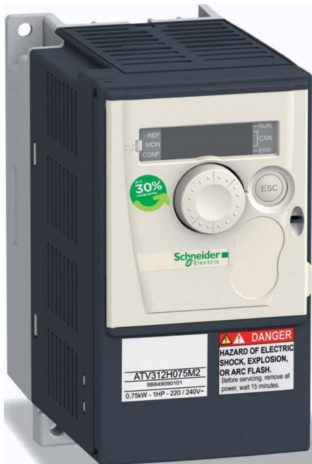
**Частотные преобразователи** предназначены для плавного регулирования скорости асинхронного двигателя за счет создания на выходе преобразователя трехфазного напряжения переменной частоты. В простейших случаях регулирование частоты и напряжения происходит в соответствии с заданной характеристикой  $V/f$ , в наиболее совершенных преобразователях реализовано так называемое векторное управление.
