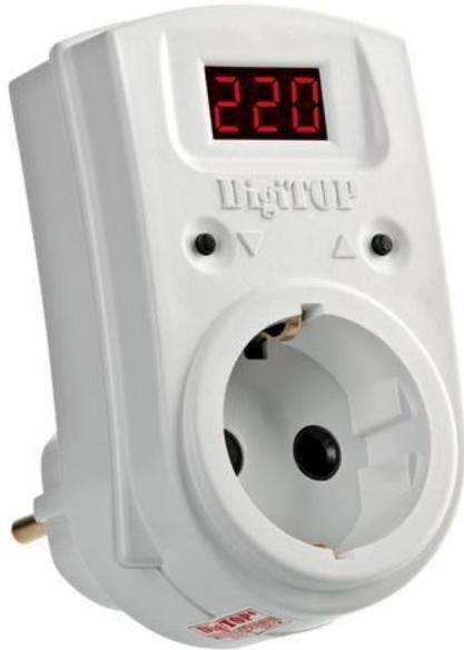
Такое реле напряжения устанавливается непосредственно в розетку и используется для защиты отдельных потребителей или их групп. Реле управляется при помощи микроконтроллера, который осуществляет анализ текущего питающего напряжения и отображает его действующее значение на цифровом табло. Отключение нагрузки осуществляется электромагнитным реле.
