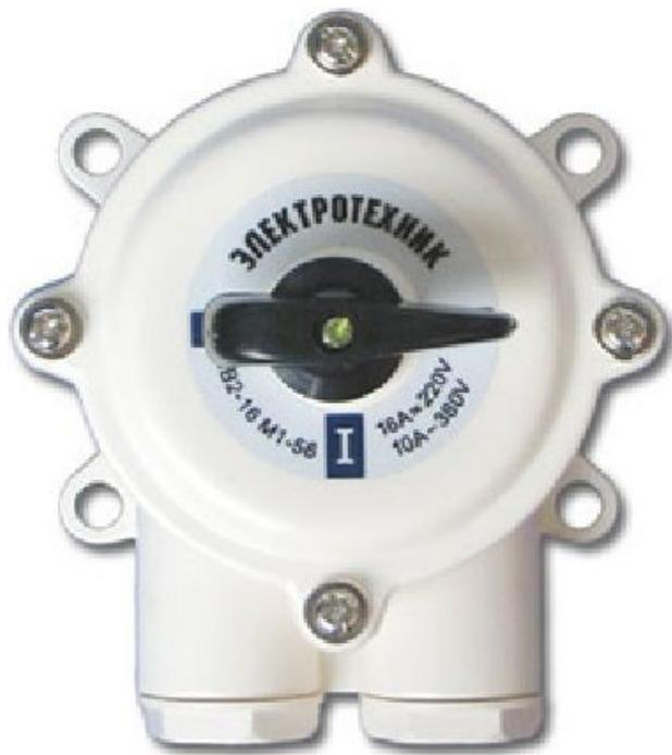
По сравнению с рубильниками пакетные выключатели имеют значительно меньшие размеры, при отключении цепи создают в ней одновременно два разрыва, а благодаря пружинному механизму мгновенного отключения, размыкание цепи происходит очень быстро, что увеличивает стойкость контактов по отношению к электрической дуге.
