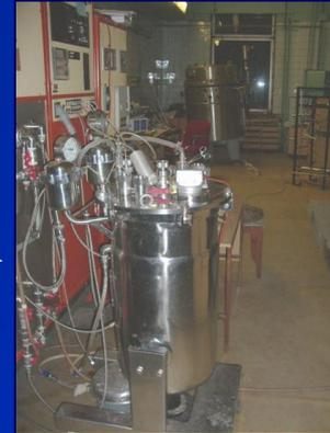
Промышленный барботажный биореактор (630 L)
