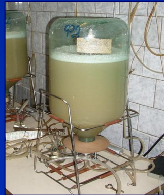
Лабораторный барботажный биореактор(20 L)
