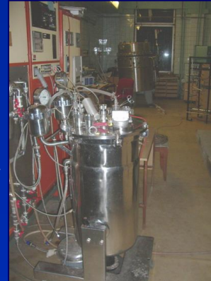
Биореактор с механическим перемешиванием (75 L)
