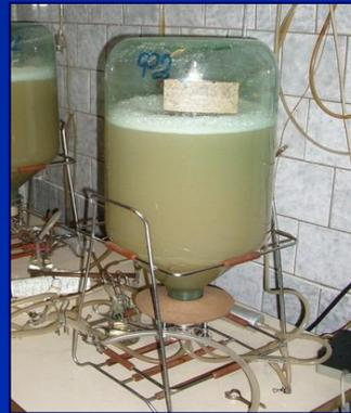
Биореактор с механическим перемешиванием (75 L)
