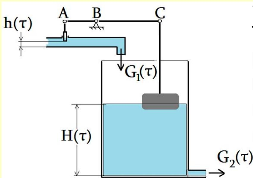
Это был первый в истории техники автоматический регулятор промышленного назначения, реализующий **принцип регулирования по отклонению.**
