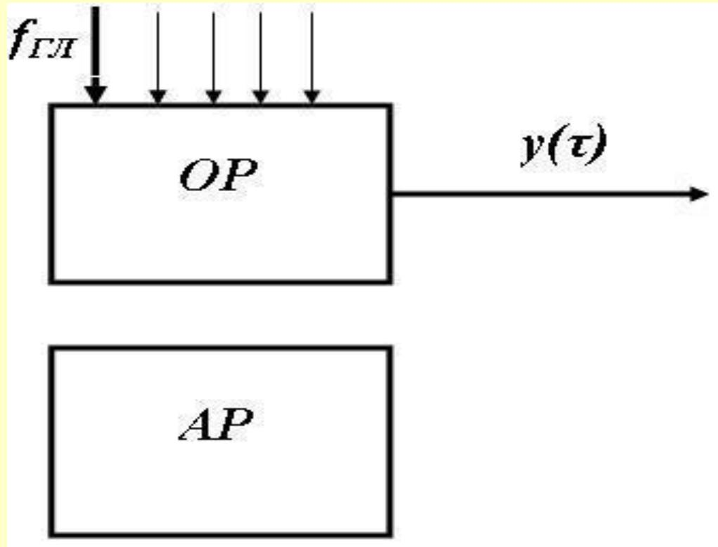
Контур АСР «по возмущению»: **ОР** – объект регулирования, **АР** – автоматический регулятор,  $f_{гл}$  – главное возмущающее воздействие,  $y(\tau)$  – текущее значение регулируемого параметра
