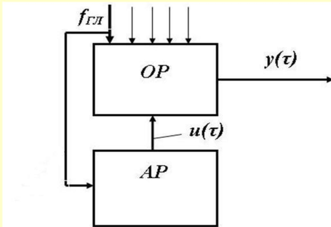
Контур АСР «по возмущению»: **ОР** – объект регулирования, **АР** – автоматический регулятор,  **$f_{ГЛ}$**  – главное возмущающее воздействие,  **$y(\tau)$**  – текущее значение регулируемого параметра,  **$u(\tau)$**  – управляющее воздействие
