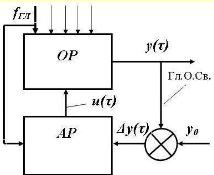
Контур комбинированной АСР: **OP** – объект регулирования, **AP** – автоматический регулятор,  $f_{гл}$  – главное возмущающее воздействие,  $y(\tau)$  – текущее значение регулируемого параметра,  $u(\tau)$  – управляющее воздействие,  $y_0$  – заданное значение регулируемого параметра; **Гл.О.Св.** – главная обратная связь
