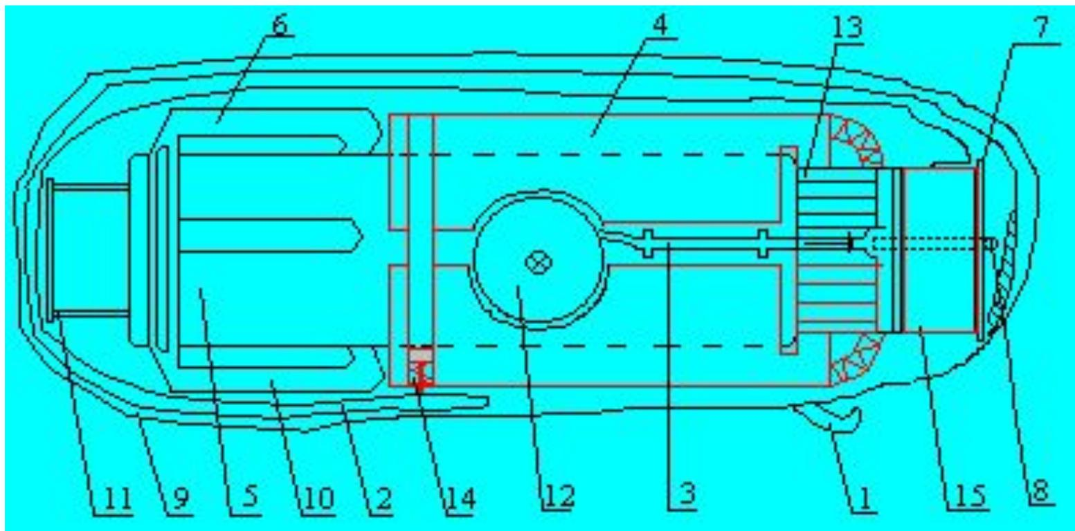
1-оболочка; 2-отражатели; 3-штуцер; 4-поплавок; 5-баллон с газовой смесью; 6-якорь; 7-стопор; 8-чека; 9-упаковочное покрытие; 10-стабилизаторы; 11-предохранительная втулка; 12-реле времени; 13- катушка, 14-сахарный предохранитель; 15- радиомаяк.
