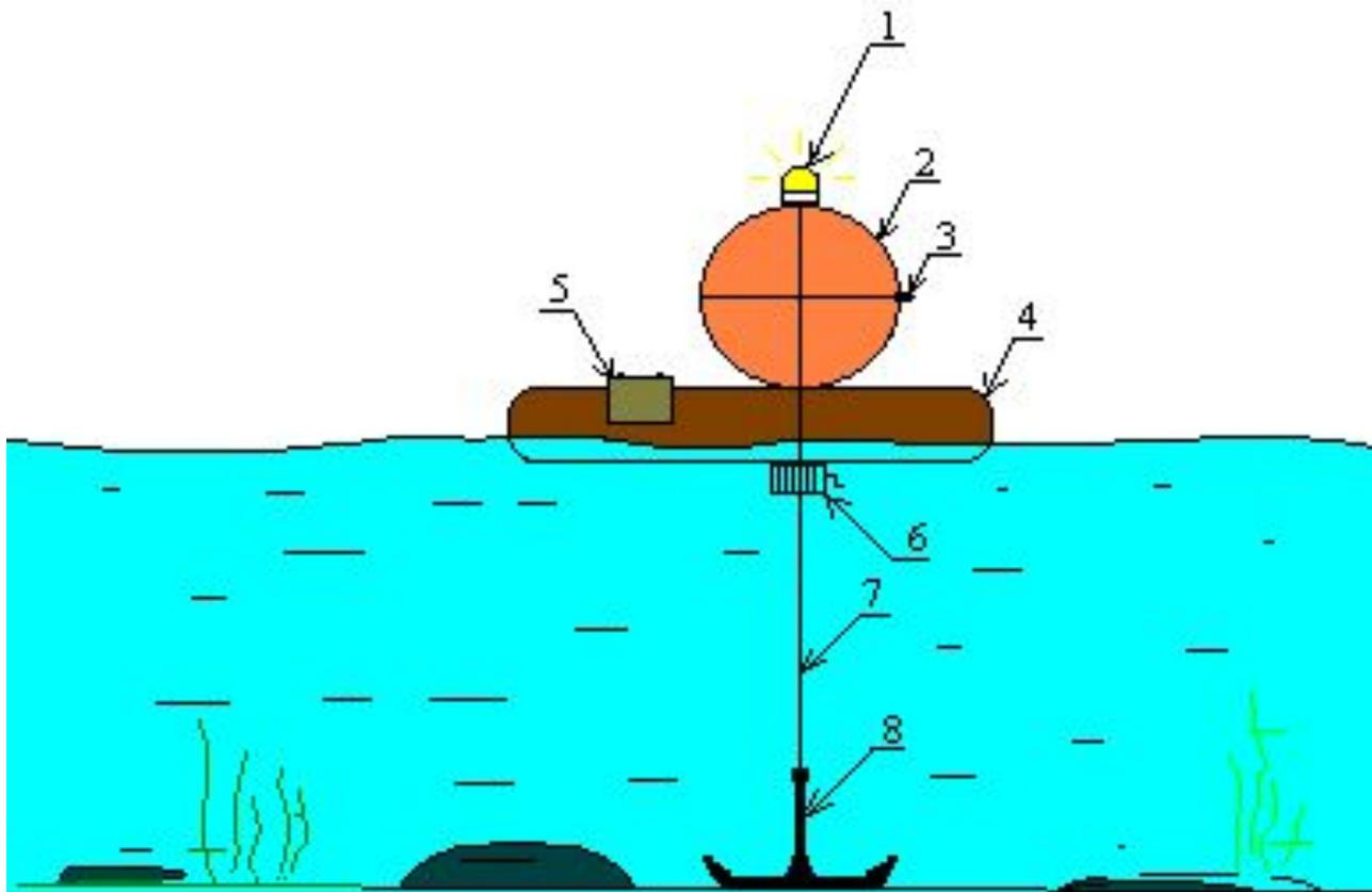
**1-сигнальный фонарь; 2-радиолокационный отражатель; 3-ниппель; 4-поплавок; 5-аккумуляторная батарея; 6-якорная лебедка; 7-якорный трос; 8-якорь.**
