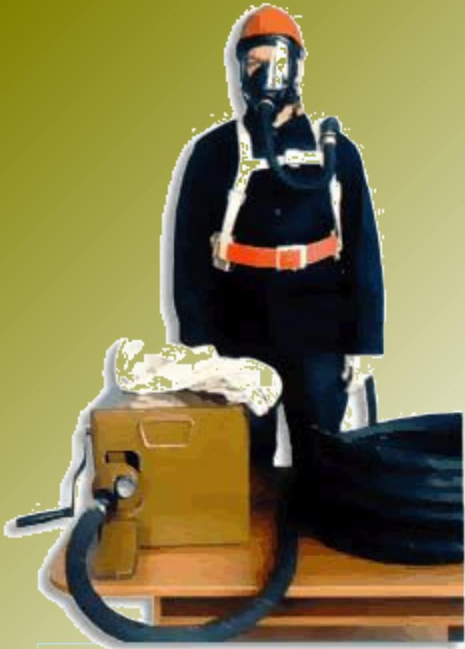
Шланговый противогаз "ПШ-2" изолирующий представляет собой **воздухонапорный** изолирующий дыхательный прибор, в котором воздух для дыхания подается по шлангу воздуходувкой, расположенной в зоне чистого воздуха.
