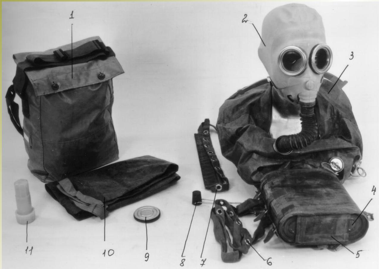
1 - сумка; 2 - шлем-маска ШИП-2М; 3 - дыхательный мешок с клапаном избыточного давления; 4 - регенеративный патрон РП-5; 5 - карман нагрудника; 6 - поясной ремень ; 7 - брасовый ремень; 8 - пробка; 9 - незапотевающие пленки; 10 - мешок для хранения; 11 - брикет для дополнительной подачи кислорода ДП-Т в футляре
