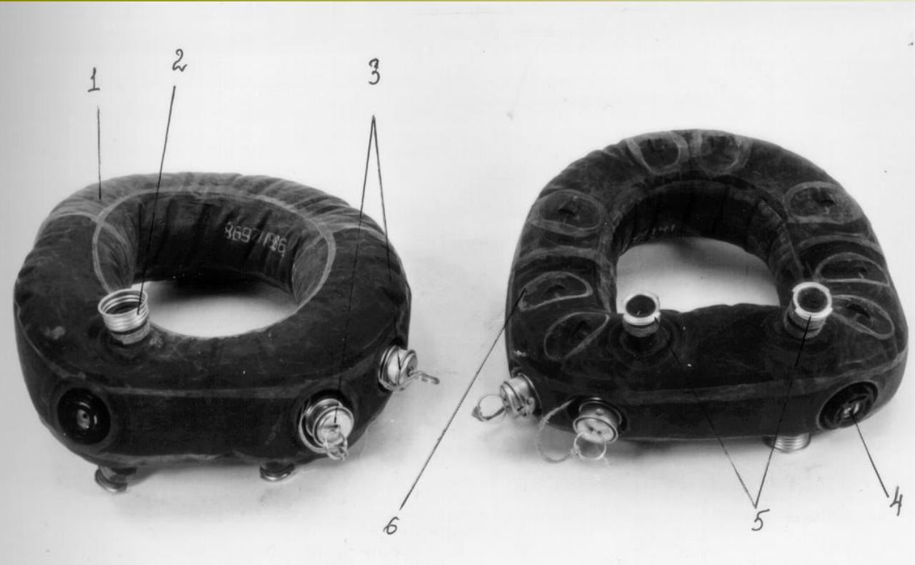
1 - корпус; 2 - гайка накидная; 3 - приспособления для дополнительной подачи кислорода; 4 - клапан избыточного давления ; 5 - ниппеля; 6 - шлевка.
