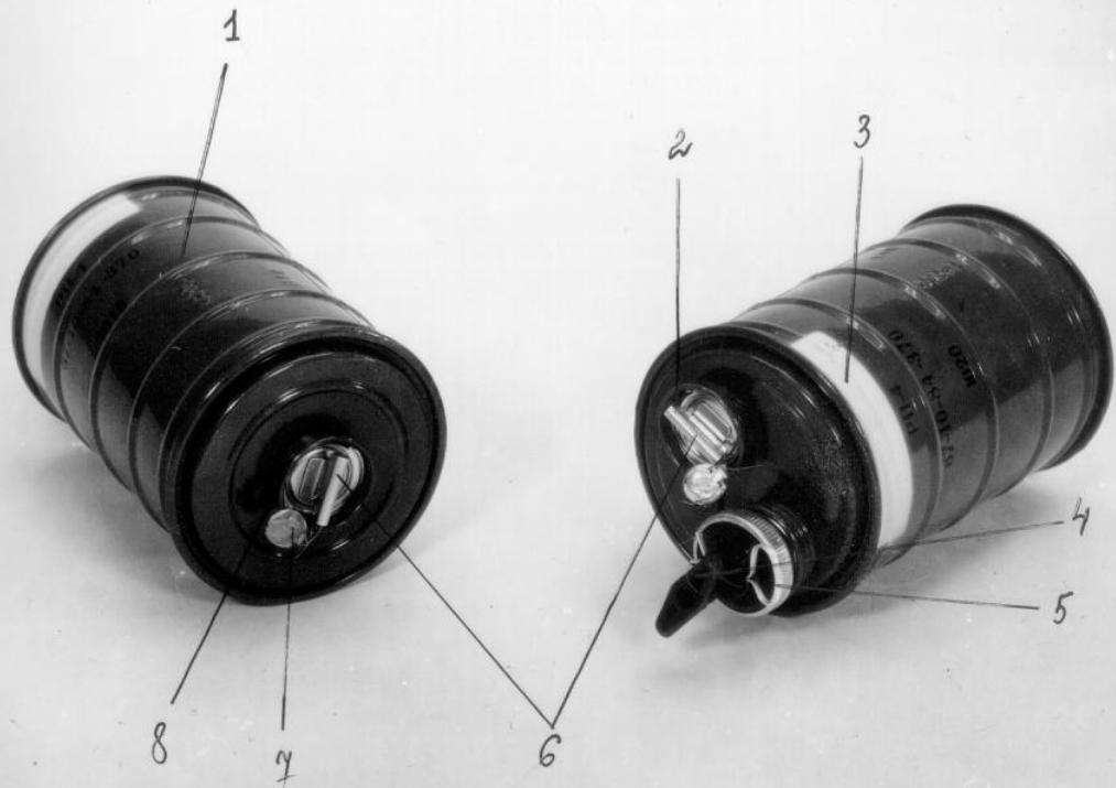
**Регенеративный патрон** предназначен для получения кислорода, а также для поглощения содержащихся в выдыхаемом воздухе диоксида углерода и паров воды. Регенеративный патрон выполнен из жести, снаряжен регенеративным продуктом на основе надперекисных соединений щелочных металлов, имеет пусковое устройство и два гнезда ниппелей для присоединения дыхательного мешка и лицевой части.
