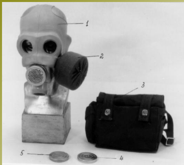
1 - шлем-маска ШМГ; 2 - фильтрующе-поглощающая коробка ЕО-18К в чехле; 3 - сумка; 4 - непотепляющие пленки; 5 - мембраны переговорного устройства
