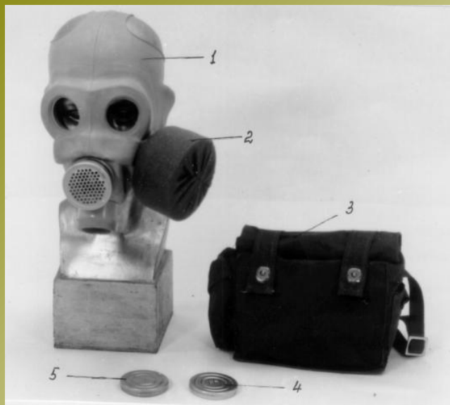
1 - шлем-маска ШМГ; 2 - фильтрующе-поглощающая коробка ЕО-18К в чехле; 3 - сумка; 4 - непотеваяющие пленки; 5 - мембраны переговорного устройства
