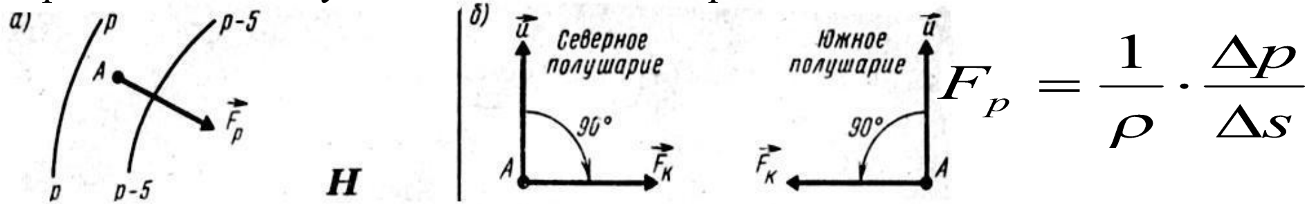
Рис. Направление сил, действующих на движущуюся массу воздуха: F_k = 2 \cdot \omega \cdot u \cdot \sin \varphi
