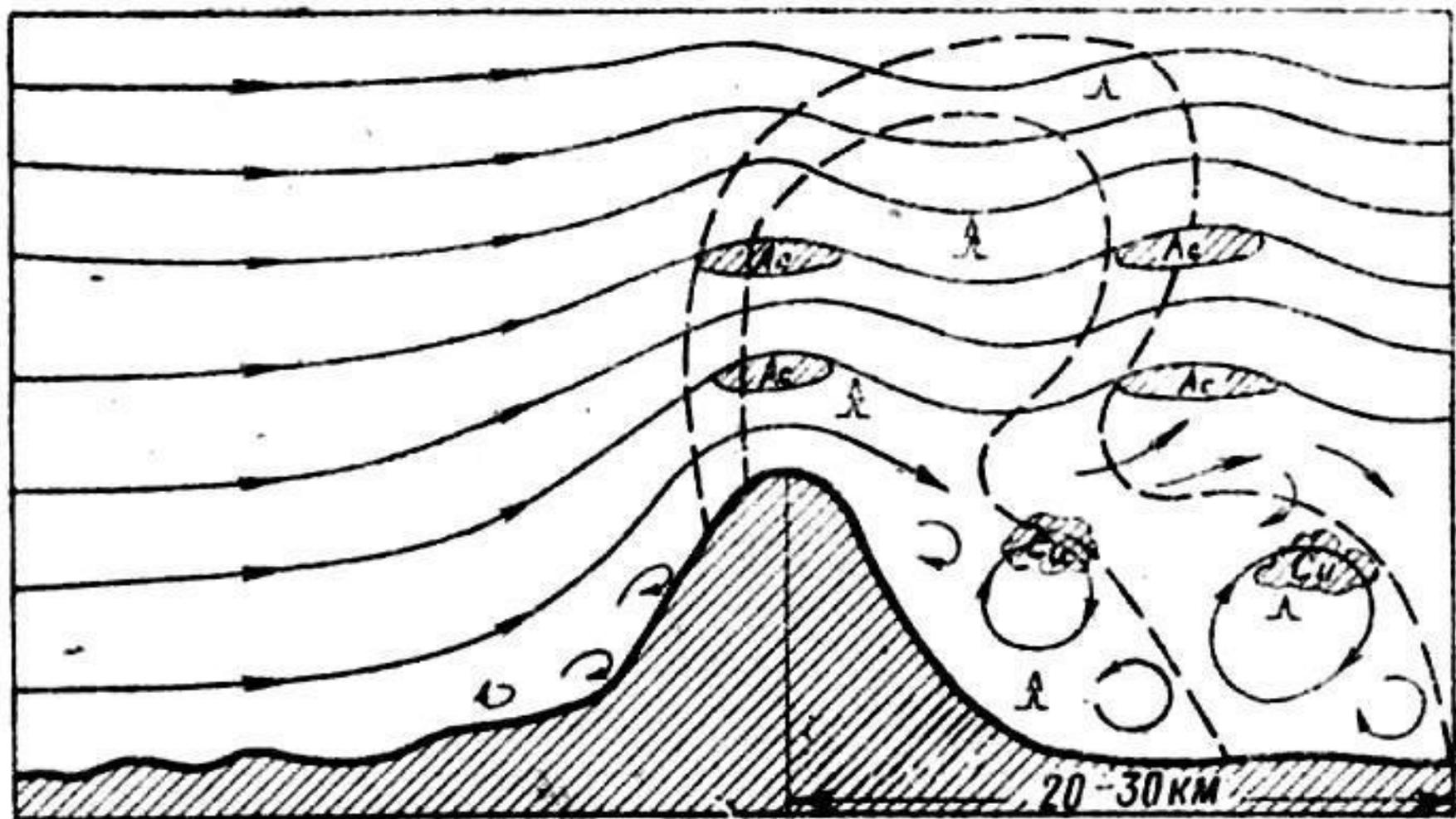
Рис. Схема расположения зон орографической турбулентности
